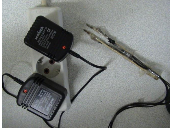
Şekil 3.4. Elektriksel uyarım için kullanılan 24 V'luk güç kaynakları.
