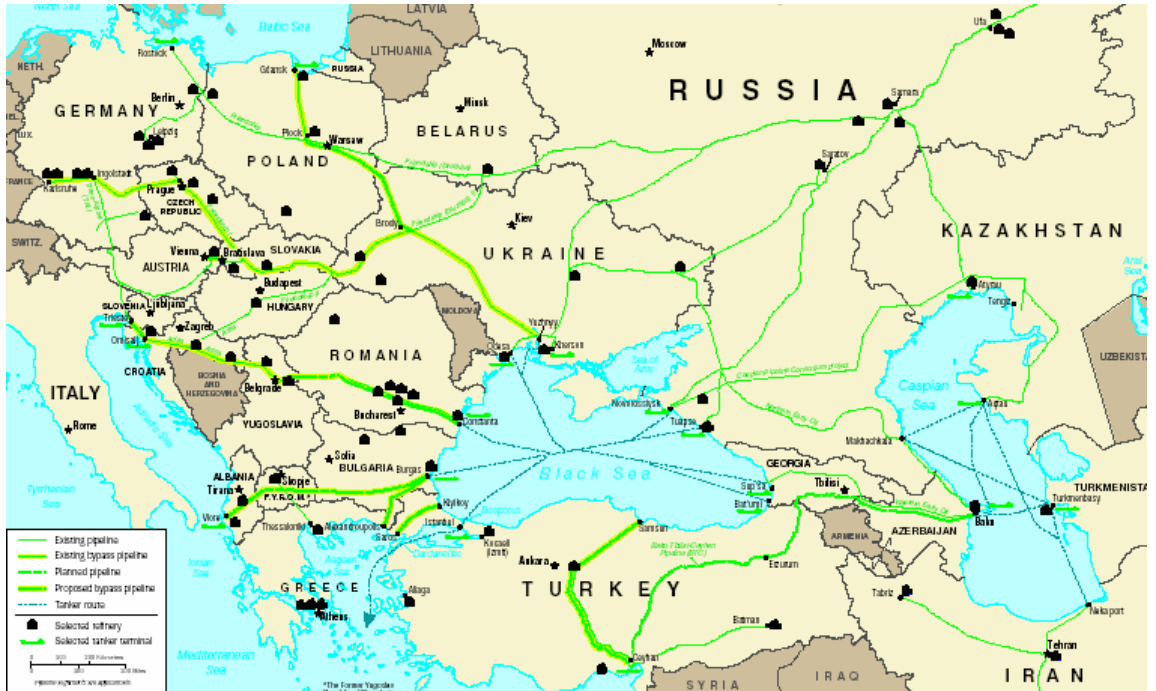
Şekil 3.7: Boğazları Devre Dışı Bırakan Boru Hatları
