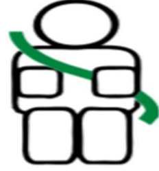
Şekil 3. Tekil Çapraz Emniyet Kemerini (34)
