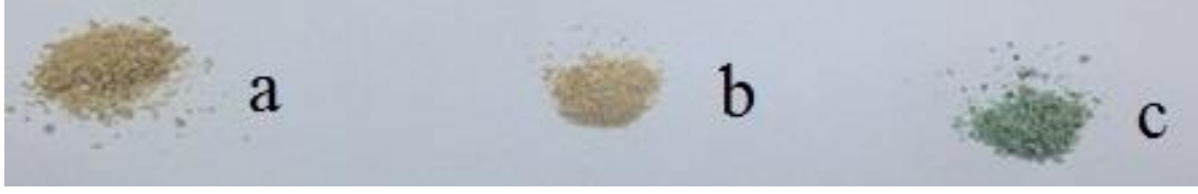
Şekil 4.1. Bal kabağı kabuğunun (a) Normal, (b) KOH işlenmiş ve (c) KOH modifikasyonlu adsorbent ile \text{Cu}^{+2} 'lu giderimi
