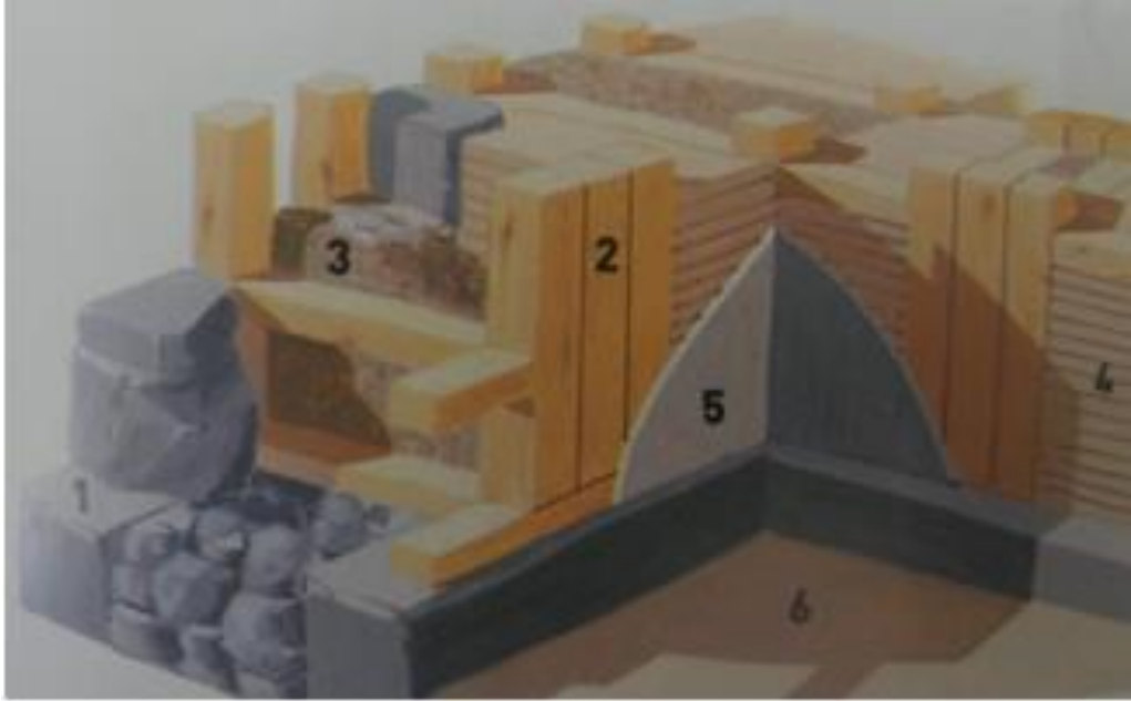
Resim 59: Hitit Yapılarında duvar yapısı: 1-taş temel/2-ahşap iskelet/3-toprak ve taş dolgu/4-kerpiç tuğlalar/5-sıva/6-sıkıştırılmış ve kireçle sıvanmış toprak zemin.
