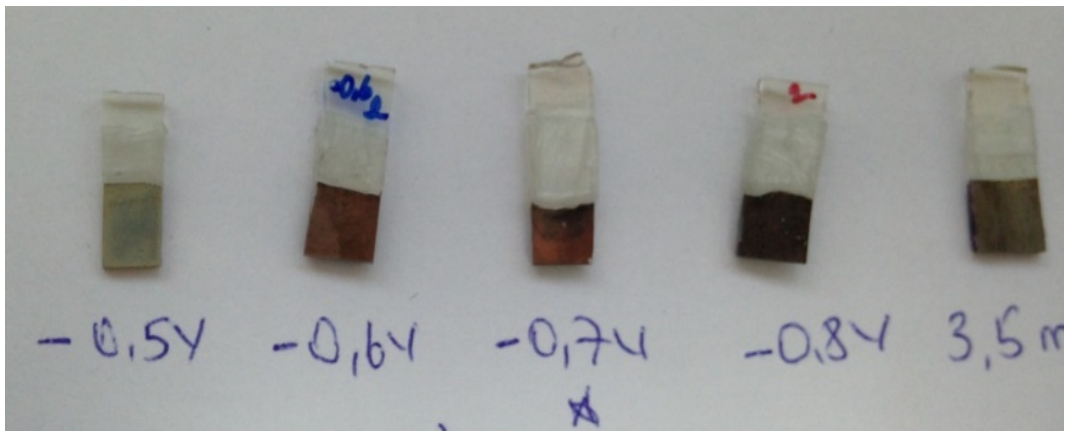
Ag-Cu= 50-50 oranında deęişik potansiyel/akımlarda elde edilen alařımlar
