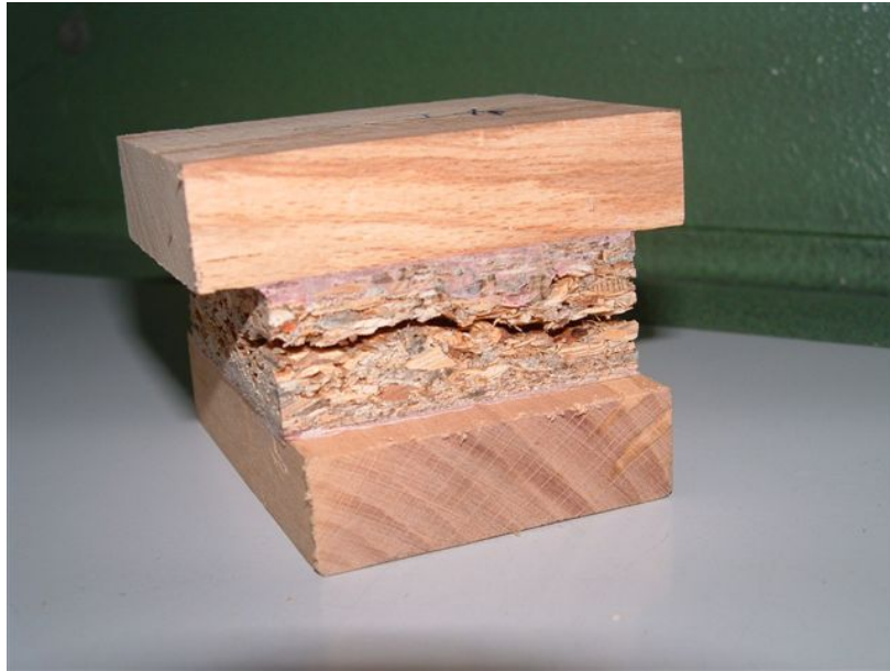
Şekil 3.10. Levha yüzeyine dik çekme deneyinden sonra numunenin görünüşü
