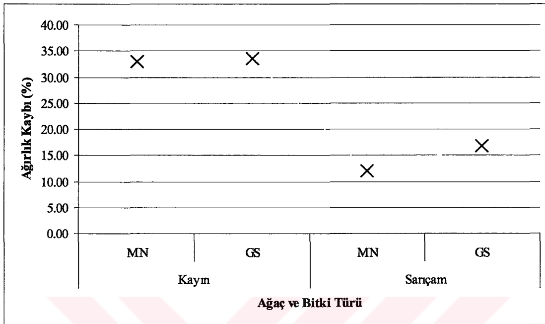
Şekil 29. Ağaç ve bitki türüne göre beyaz çürüklük mantarına ( Trametes versicolor ) karşı ağırlık kaybı değerlerinin ortalamalarının karşılaştırılması
