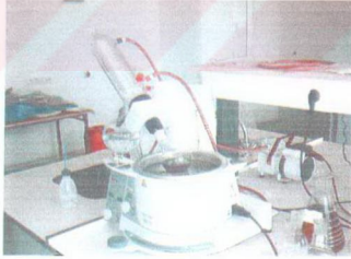
Şekil 5. Döner kurutucu ile ekstrakta bulunan etil alkolün ayrıştırılması
