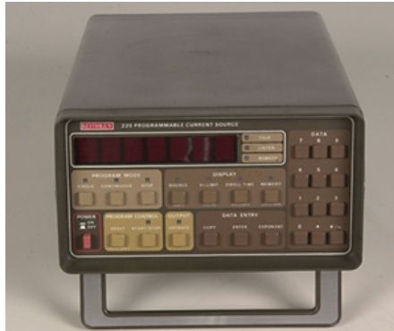
Şekil 3.4. Keithley 220 programlanabilir sabit akım kaynağı
