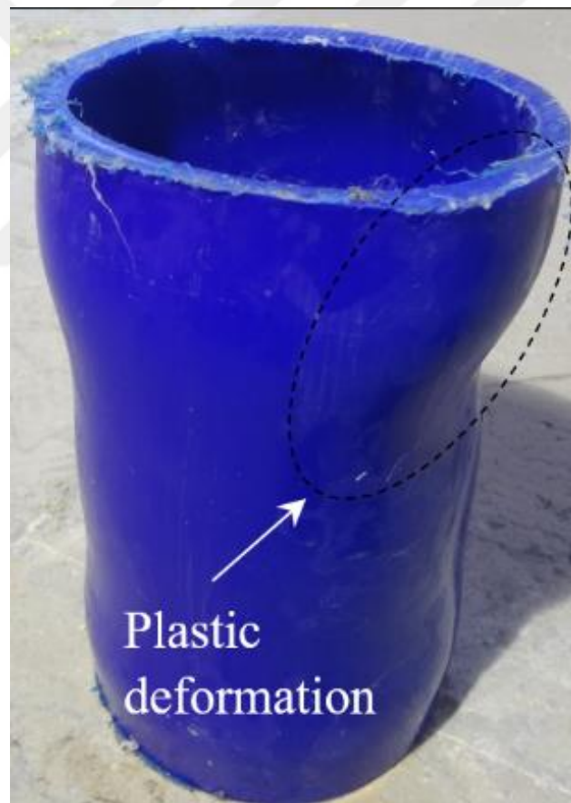
Figure 3.4 (d) Failure type of hollow (H) specimens
