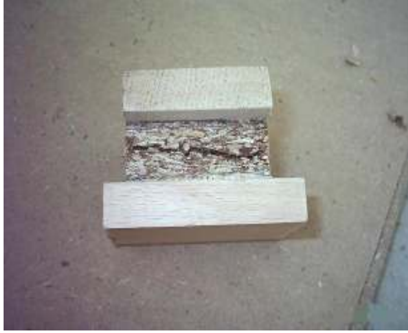
Resim 12. Levha yüzeyine dik çekme deneyinden sonra numunenin görünüşü
