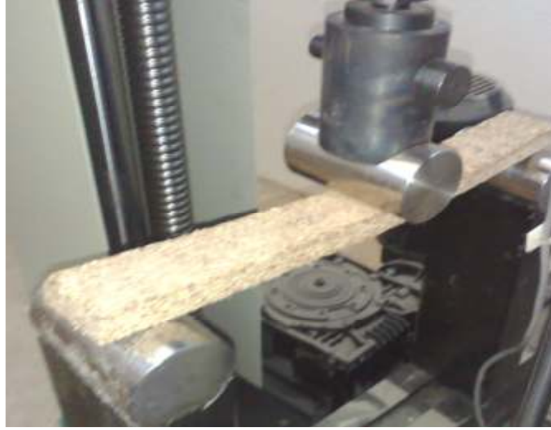
Resim 13. Eğilme direncinin ve elastikiyet modülü testi
