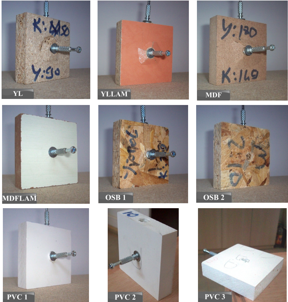
Resim 14. Minifiks tutma mukavemeti sonucunda meydana gelen göçme tipleri
