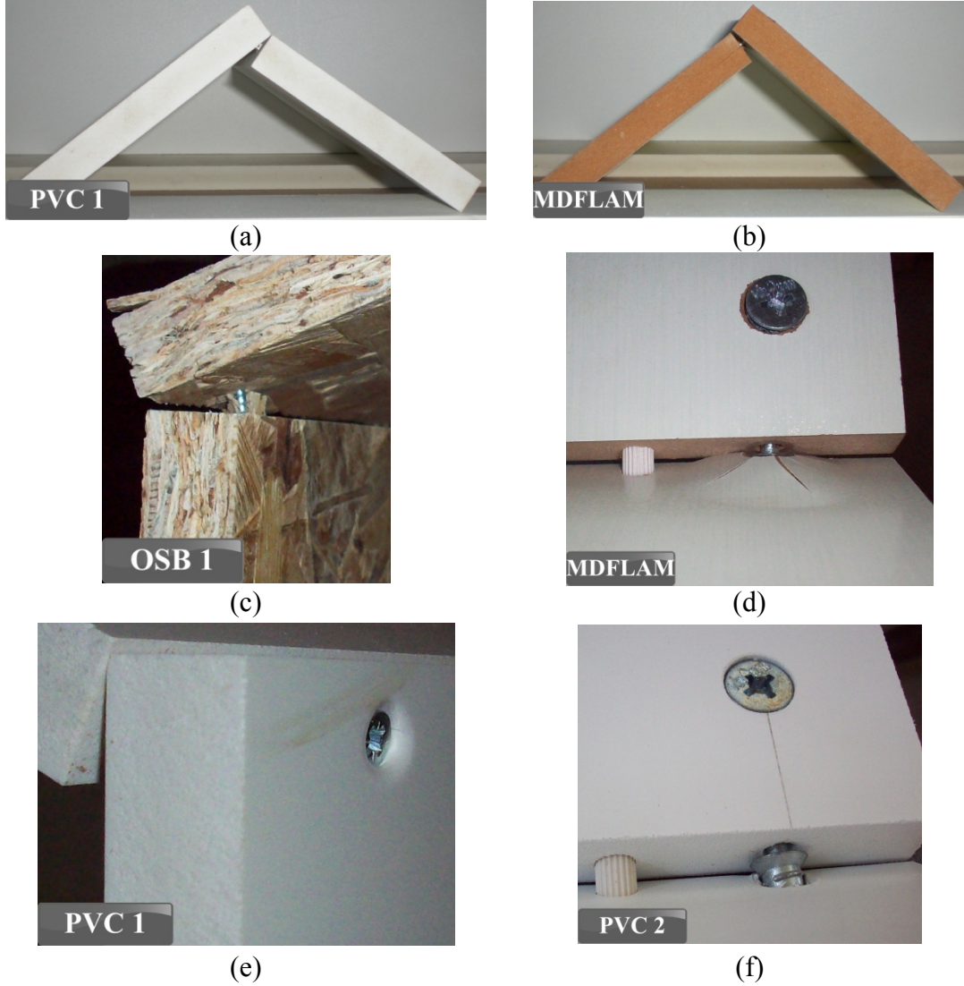
Resim 15. Vidalı (a, b, c, e) ve minifiksli (d, f) diyagonal çekme deneyleri sonucunda meydana gelen göçme tipleri
