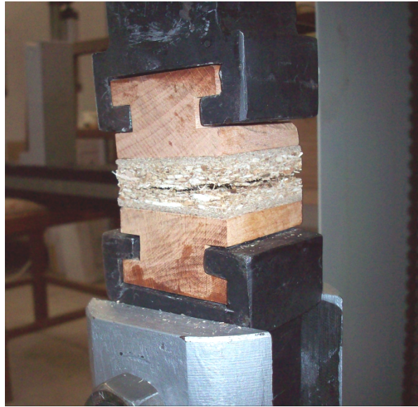
Resim 3. Levha yüzeyine dik çekme deneyi test düzeneği
