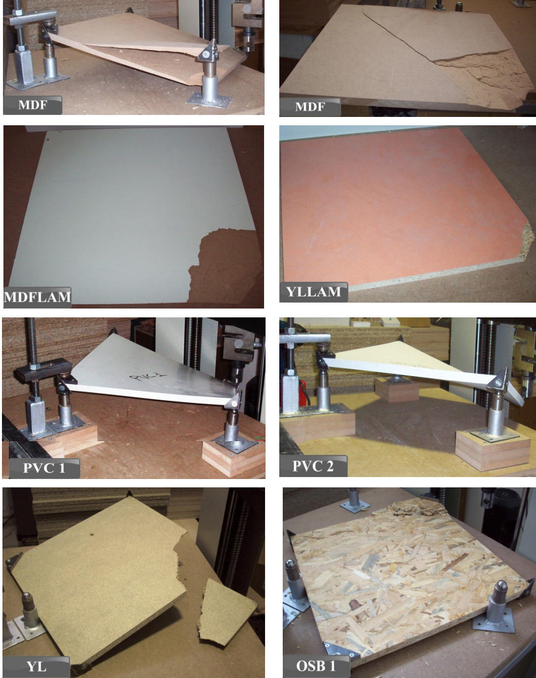
Resim 12. Rijitlik modülü deneyleri sonucu meydana gelen göçme tipleri
