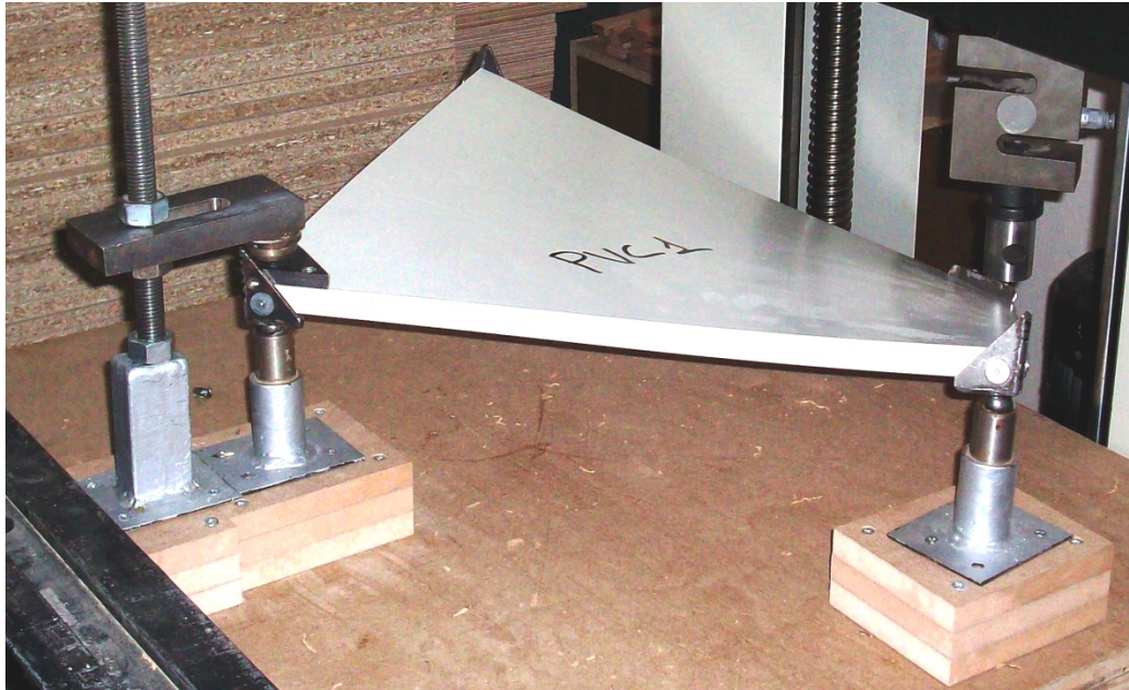
Resim 4. Panel rijitliği modülü deney düzeneği ve yük uygulama biçimi
