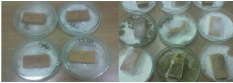
Şekil 3.6. Kahverengi çürüklük mantarı aşılanan deney örneklerinin inkübatöre konması
