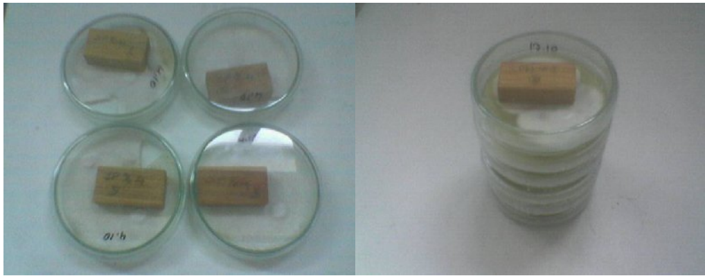
Şekil 3.5. Kahverengi çürüklük mantarlı besi ortamına yerleştirilen deney örneklerinin inkübatöre koymak için hazır hale getirilmesi
