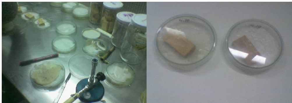
Şekil 3.4. Deney parçalarının kahverengi çürüklük mantarlı besi ortamı olan petri kaplarına yerleştirilmesi
