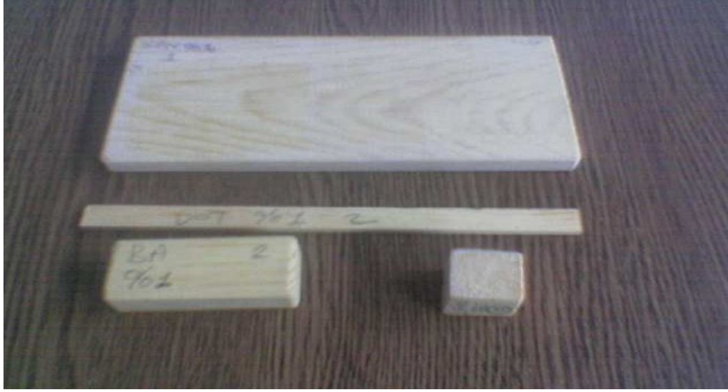
Şekil 3.2. Deneysel çalışmalar kapsamında hazırlanan sarıçam deneysel örnekleri
