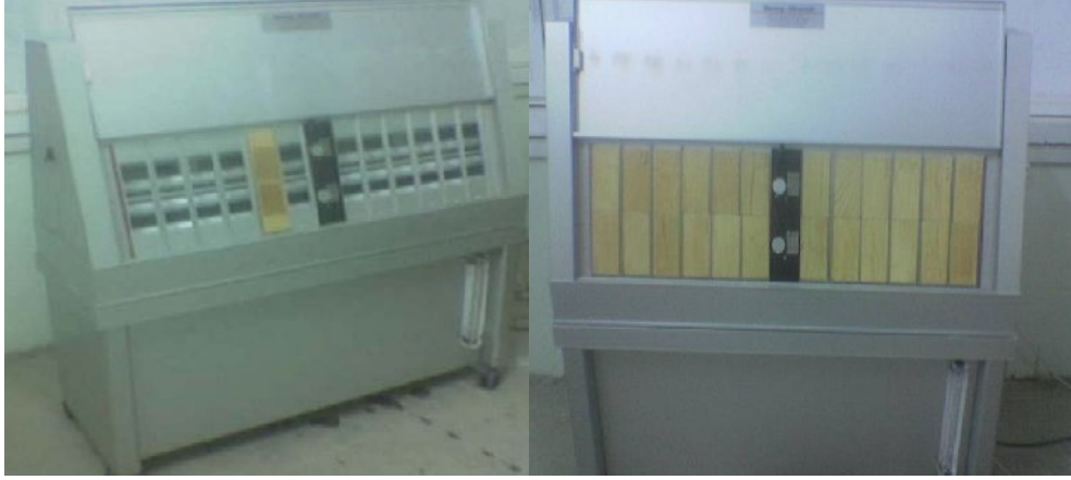
Şekil 3.13. Deney örneklerinin yaşlandırma makinasına yerleştirilmesi
