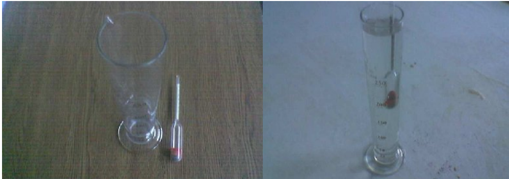
Şekil 3.24. Emprenyede kullanılan çözeltilerin yoğunluğunun ölçülmesi
