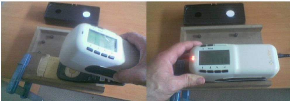
Şekil 3.16. Deney örneklerinin X-Rite marka ölçüm cihazında renginin ölçülmesi
