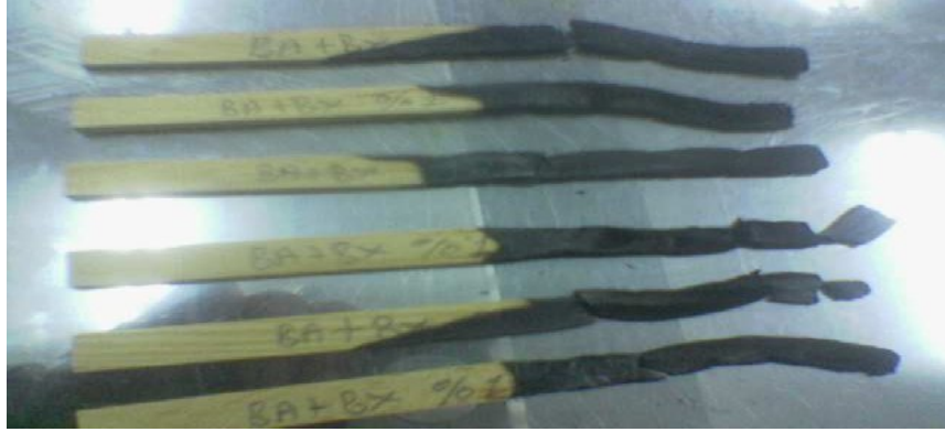
Şekil 3.12. Deney örneklerinin oksijen indeks cihazında tutuşup yanan kısımları
