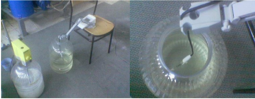
Şekil 3.23. Emprenyede kullanılan çözeltilerin pH'ının ölçülmesi
