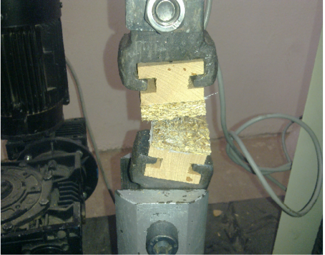
Resim 4. 24. Levha yüzeyine dik çekme deneyinden sonra numunenin görünüşü.
