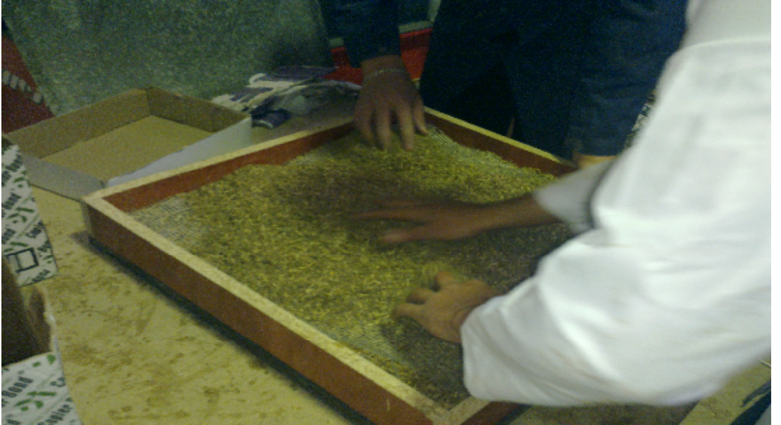
Resim 4.17. Sıva filesi üzerine orta katman yongalarının serilmesi
