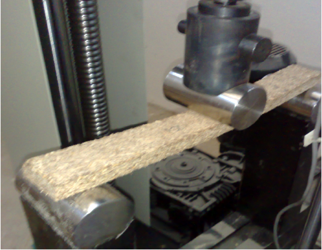
Resim 4.25. Eğilme direncinin ve elastikiyet modülü testi
