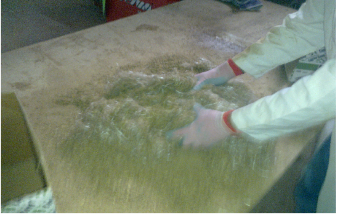
Resim 4.20. Kort bezi lifi, polyester elyafı lifi ve cam elyafı lifinin üst ve orta tabaka yongalarına homojen bir şekilde karıştırılması.
