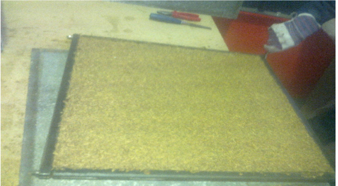
Resim 4.13. Presleme sonrası yonga levhanın sökülerek soğumaya bırakılması.
