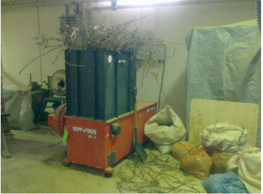
Resim 4.2. Üniversal kırma (yongalama) makinesi
