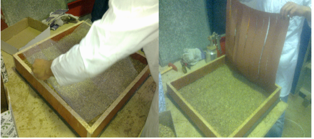
Resim 4.16. Üst tabaka yongaları üzerine tutkallanmış sıva filesi ve kord bezinin serilmesi
