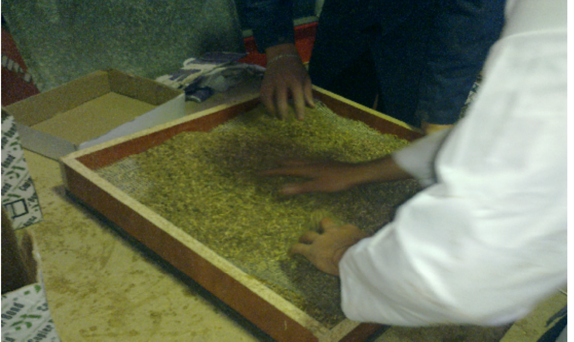
Resim 4.19. Sıva filesi üzerine üst tabaka yongalarının serilerek prese hazırlanması
