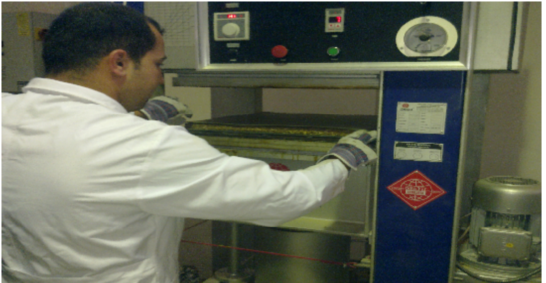
Resim 4.11. Yonga levha üzerine presleme öncesi metal saçın koyulması.
