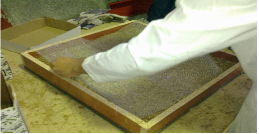
Resim 4.18. Orta tabaka üzerine tutkallanmış sıva filesinin serilmesi
