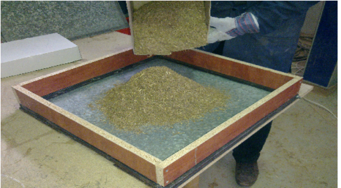
Resim 4.15. Üst katman yongalarının kalıba dökülerek serilmesi.
