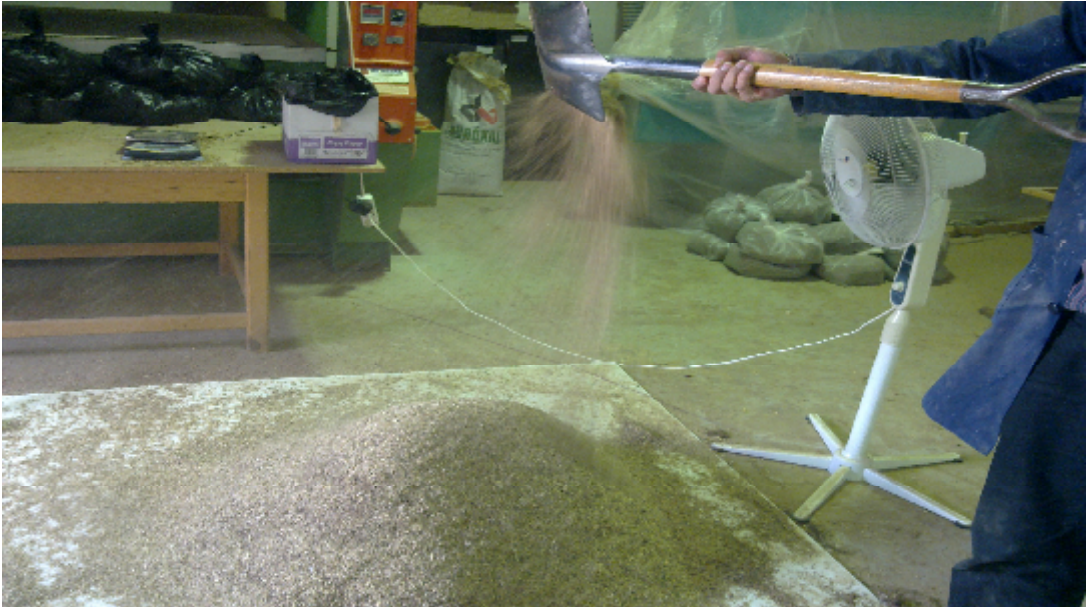
Resim 4. 4. Elenen orta ve üst tabaka yongalarının harmanlanarak tozdan arındırılması
