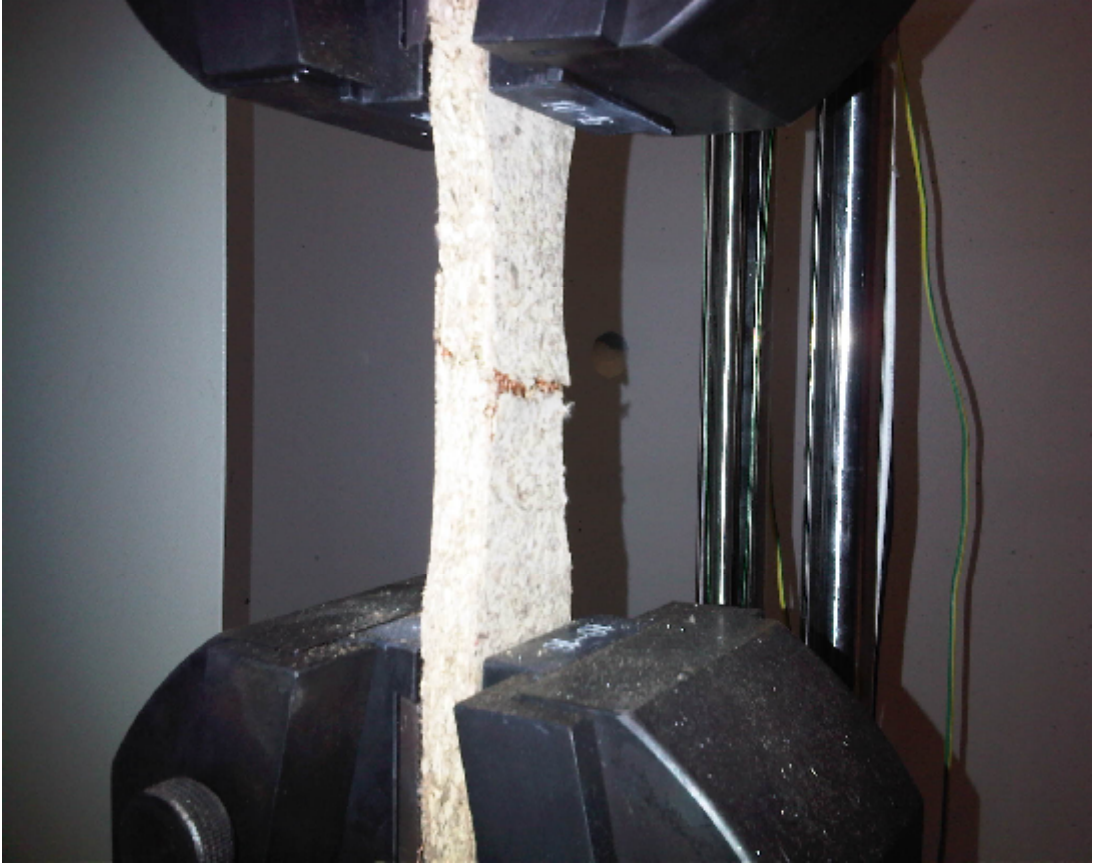
Resim 4.26. Levha yüzeyine paralel çekme deneyinin yapılışı
