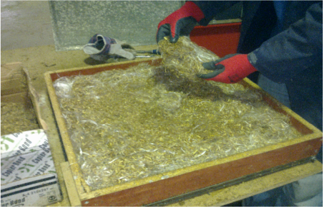
Resim 4.22. Tutkallanan üst ve orta katmanların kalıp içerisinde homojen bir şekilde dağıtılması
