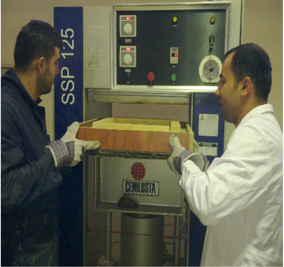
Resim 4.8. Tutkallanmış yongaların kalıp içerisinde ön preslemesinin yapılması
