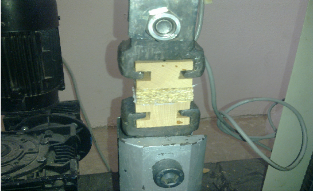
Resim 4. 23. Levha yüzeyine dik çekme deneyinin yapılışı
