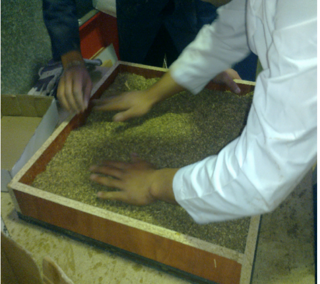
Resim 4. 7 Yongalarının homojen bir řekilde dađıtılıp serilmesi
