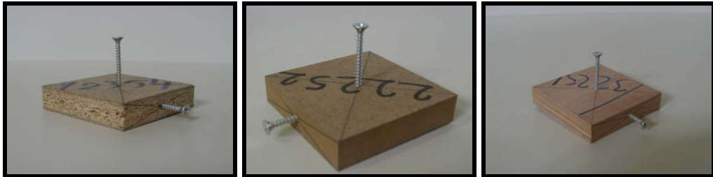
Resim 3.2. Vida tutma mukavemeti deney örnekleri
