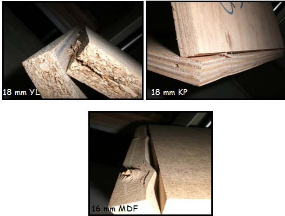
Resim 4.6. L-tipi birleştirmelerde, diyagonal çekme ve diyagonal basınç yükü altındaki kırılma şekilleri
