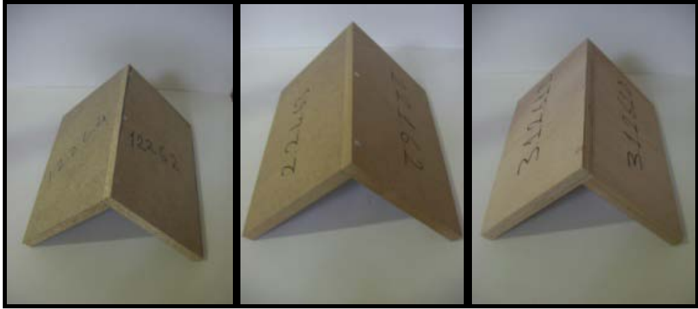
Resim 3.5. Diyagonal çekme deneyi deney örnekleri
