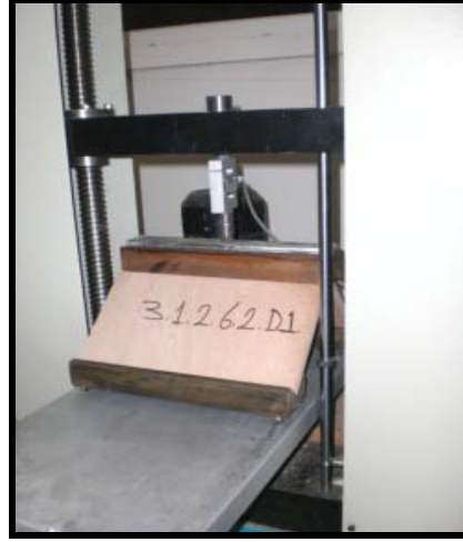
Resim 3.6. Diyagonal çekme deneyinin uygulanması
