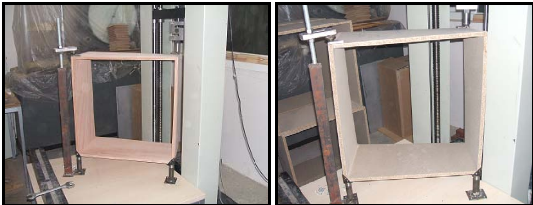
Resim 4.7. Kutu rijitliği deneyi kutu deformasyon şekilleri
