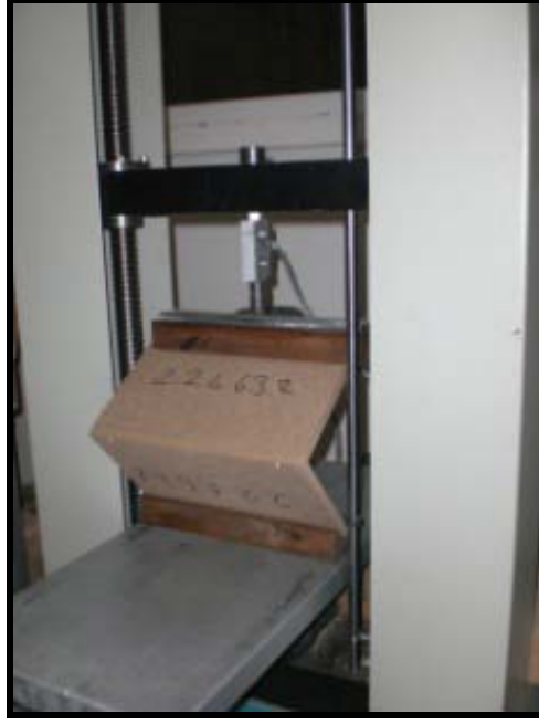
Resim 3.7. Diyagonal basınç deneyinin uygulaması
