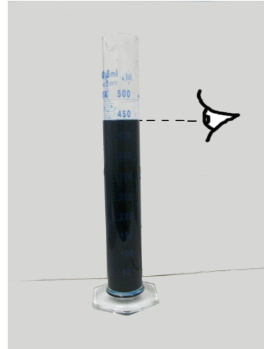
ekil 1.14. Dereceli silindirin gösterdiği değerin okunması
