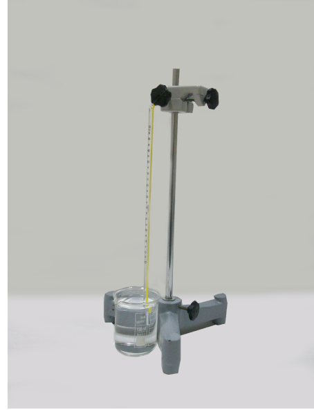
ekil 1.19. Termometrenin sıvı içerisindeki konumu
