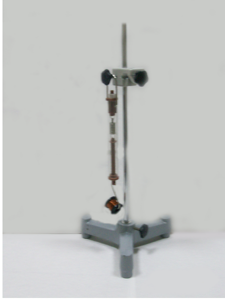
ekil 1.11. Dinamometreye cisim asılması
