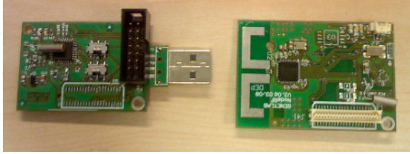
Şekil 4.11 USB programlayıcı ve SenseNode v1.3 algılayıcı düğümü
