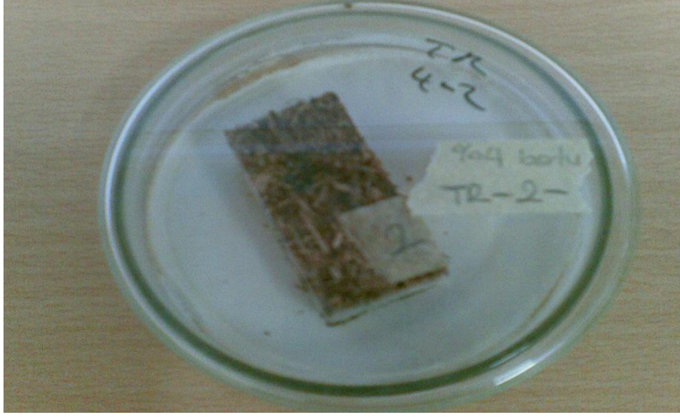
Şekil 4.21. Mantar saldırısına maruz kalmış %4 borlu deney örneği
