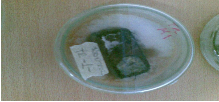
Şekil 4.19. Mantar saldırısına maruz kalmış kontrol (emprenyesiz) deney örneği
