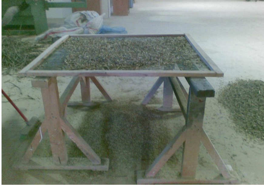
Şekil 4.2. Eleme işlemi ve budama artığı yongaları
