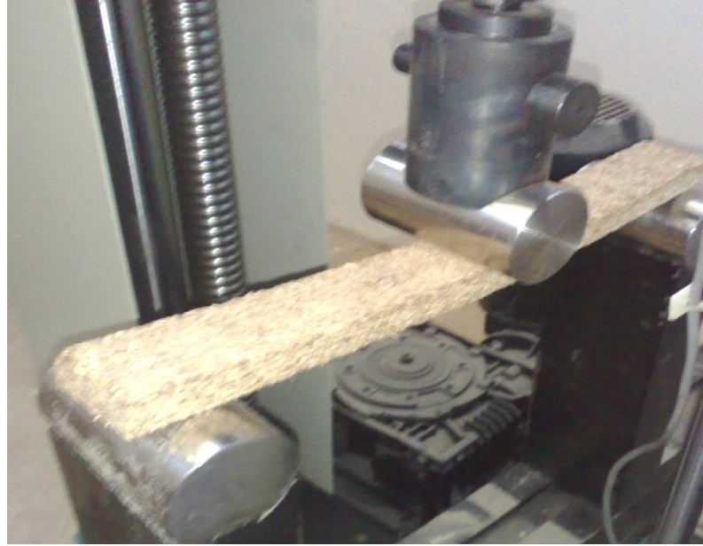
Şekil 4.16. Eğilme direnci ve elastikiyet modülü testi
