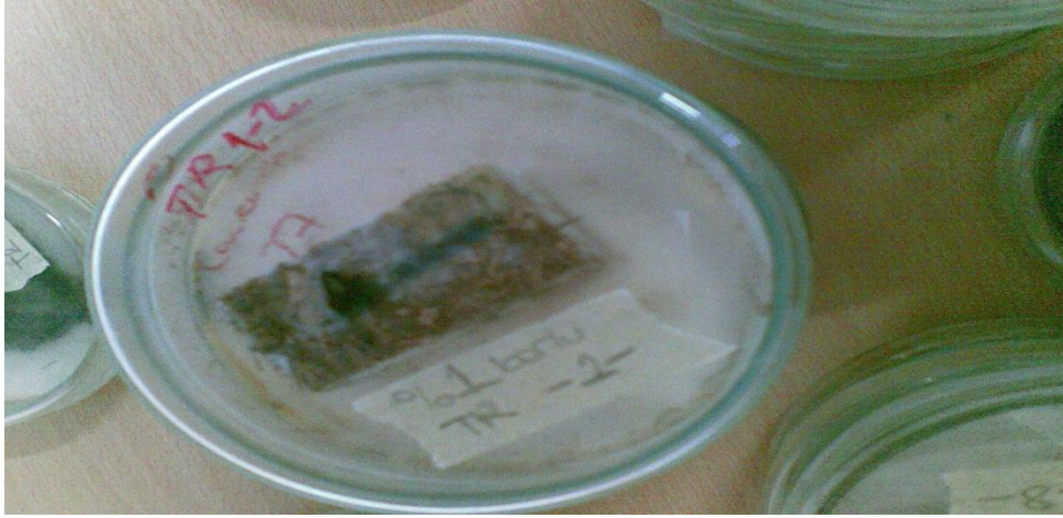
Şekil 4.20. Mantar saldırısına maruz kalmış %1 borlu deney örneği
