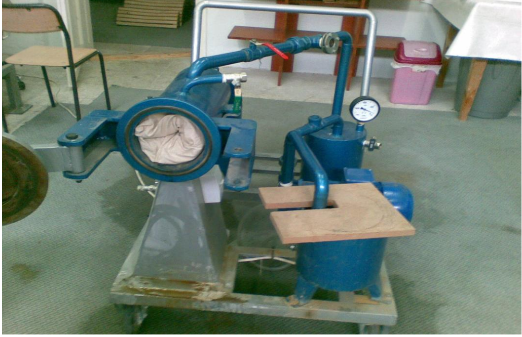
Şekil 4.5. Çalışmada kullanılan emprenye silindiri ve ekipmanı
