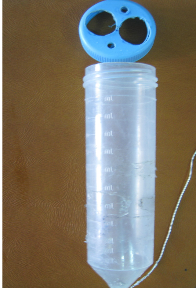
Şekil 2.4. Polietilen biyosentri-voltammetrik hücre
