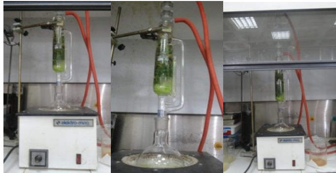
Şekil 2.1. Çalışılan bitkilerin soksalet cihazı ile ekstraksiyonu
