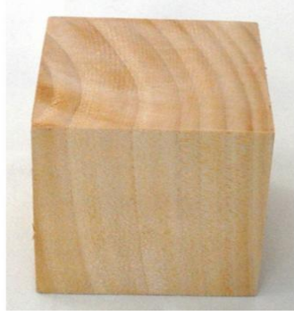
Şekil 3.1. Yoğunluk ve rutubet deney örneği
