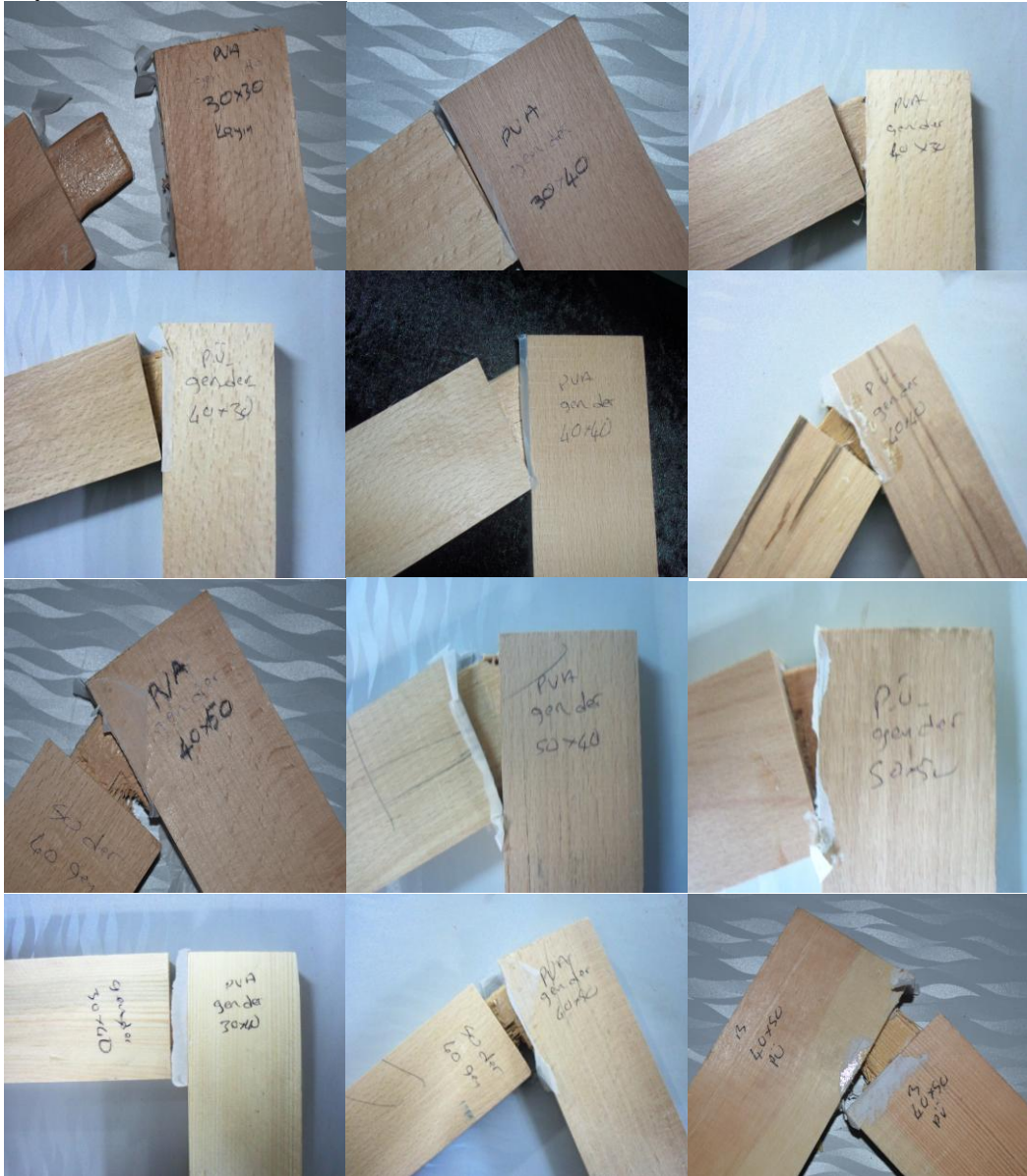
Şekil 4. 1. Basınç deneylerinde gözlenen birinci deformasyon biçimi
