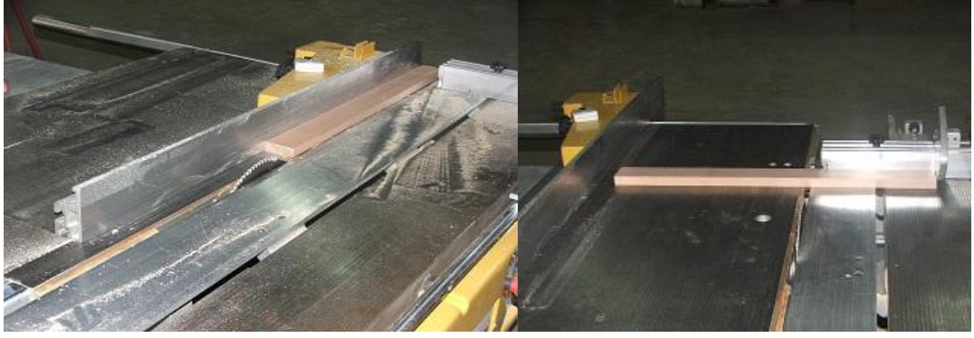
Şekil 3.8. Daire testere makinesinde en ve boy kesimi
