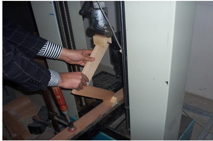
Şekil 3.15. Diyagonal basınç deney düzenekleri
