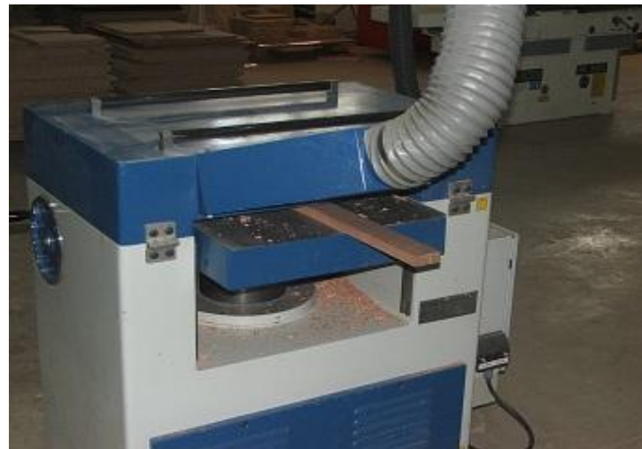
Şekil 3.7. Kalınlık makinesinde kalınlığın çıkarılması
