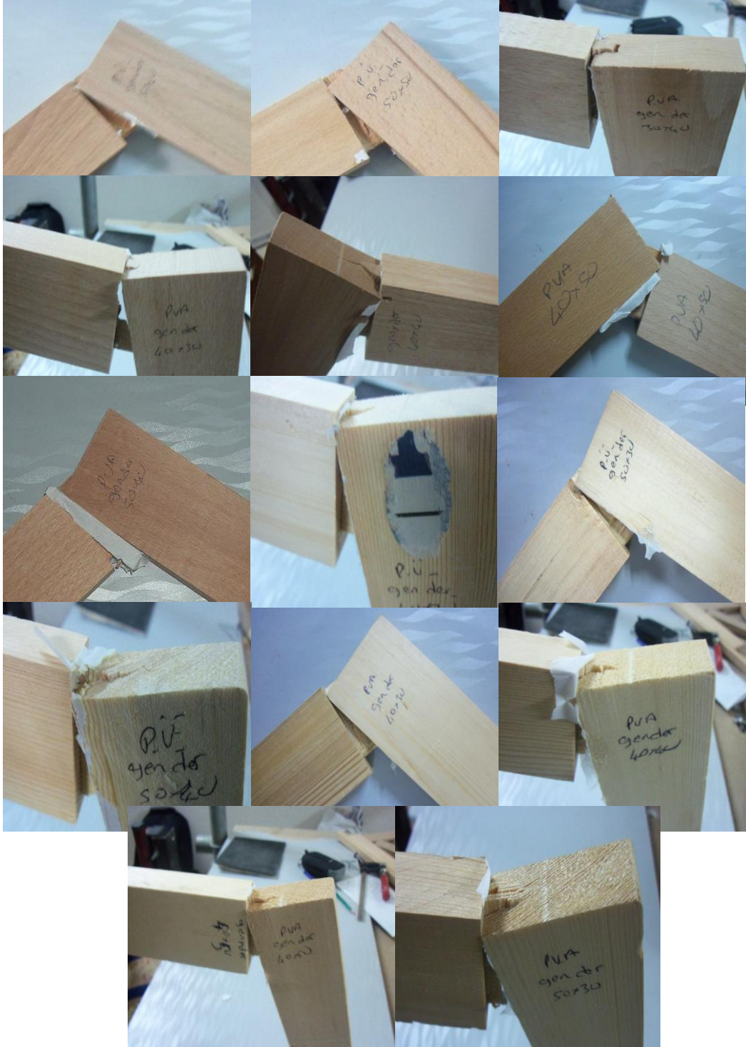
Şekil 4.6. Çekme deneylerinde gözlenen üçüncü deformasyon biçimi
