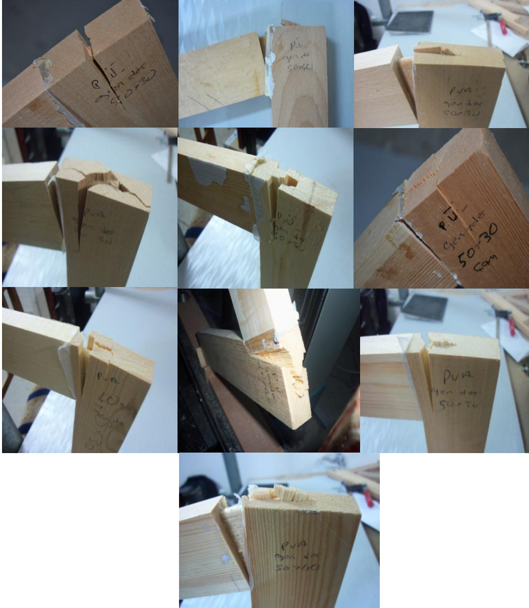
Şekil 4.3. Basınç deneylerinde gözlenen üçüncü deformasyon biçimi
