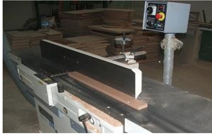
Şekil 3.6. Planya makinesinde yüz, cumba açılması
