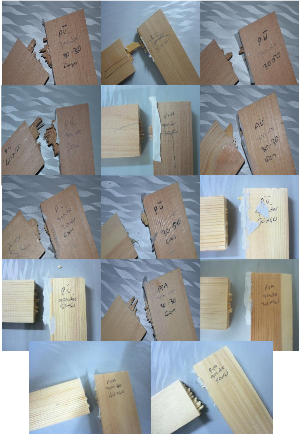
Şekil 4.2. Basınç deneylerinde gözlenen ikinci deformasyon biçimi
