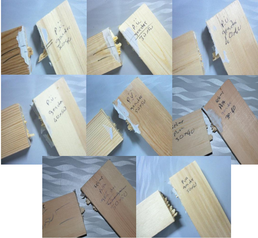
Şekil 4.5. Çekme deneylerinde gözlenen ikinci deformasyon biçimi
