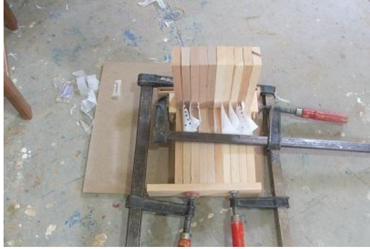
Şekil 3.13. İşkencelerle sıkılmış 10'lu deney numuneleri
