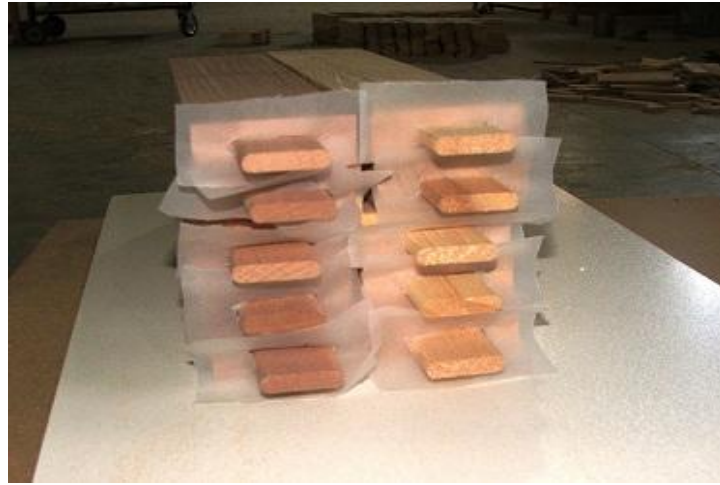
Şekil 3.12. Yağlı kağıt ile kaplanmış erkek zıvanalar
