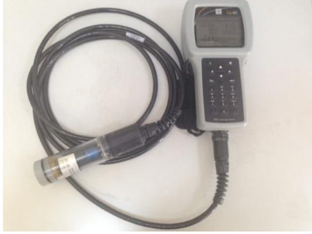
Şekil 3.7. YSI556 MPS multi parametre ölçüm cihaz
