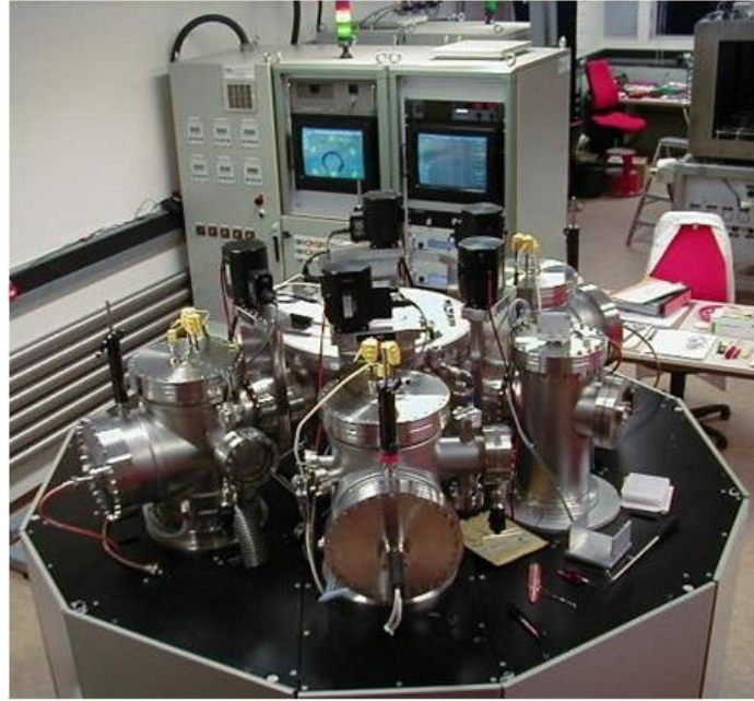
Şekil 2.15. Bu tezde incelenen kalın mikrokristal silisyum malzemelerin büyütüldüğü çok odalı VHF-PECVD sisteminin resmi (Julich Araştırma Merkezi, Fotovoltaik Enstitüsü (IPV-5) Julich, Almanya)
