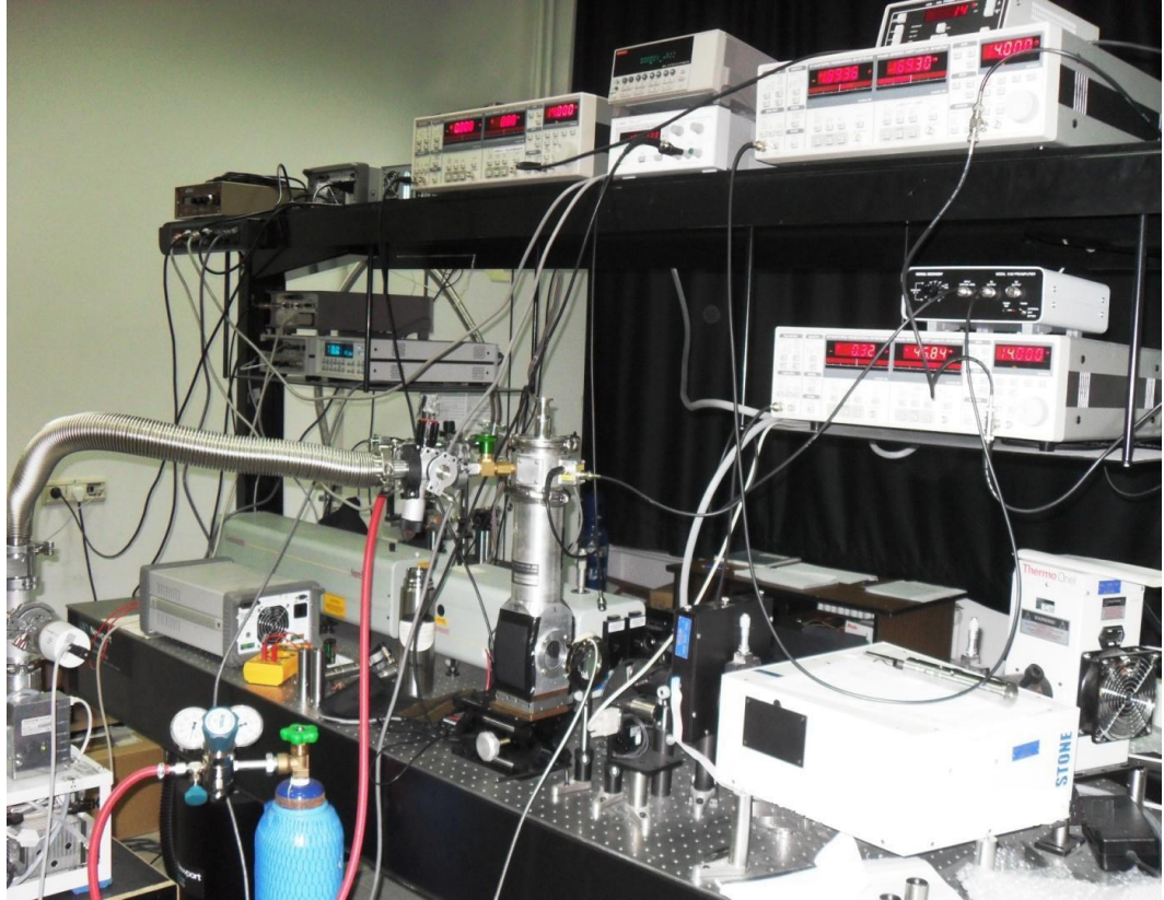
Şekil 2.32. Silisyum film malzemelerin optiksel özelliklerinin incelendiği İki Demetli Fotoiletkenlik sisteminin resmi (Muğla Sıtkı Koçman Üniversitesi)
