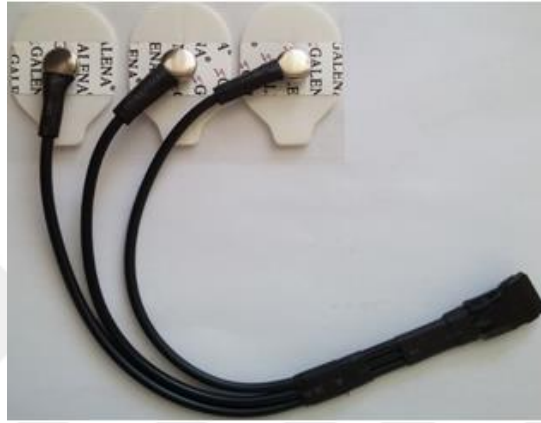
Şekil 5.2. Yüzey elektrotları ve bağlantı kablosu
