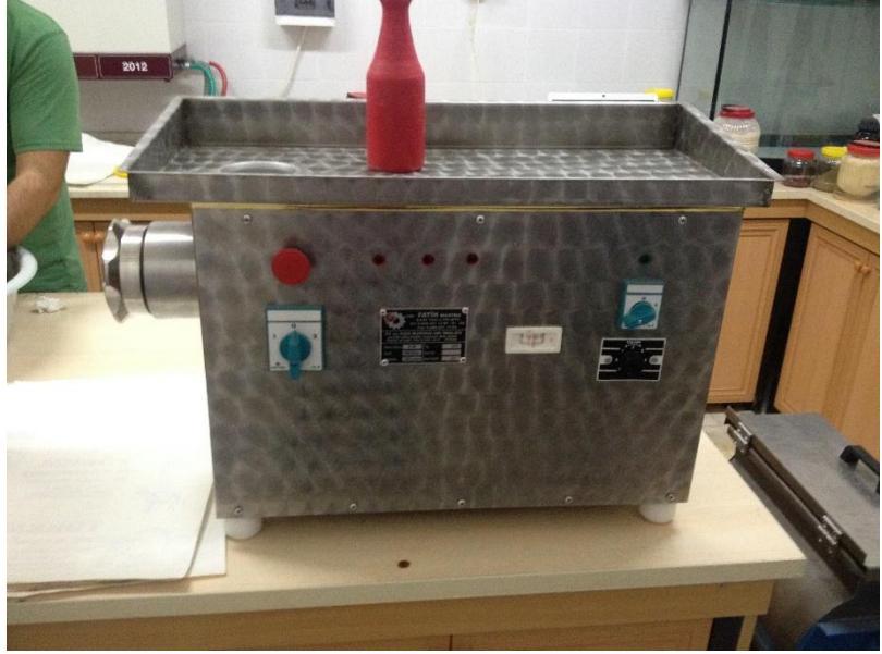
Şekil 3.7. Yemleri hazırlamada kullanılan soğutmalı yem yapım makinesi
