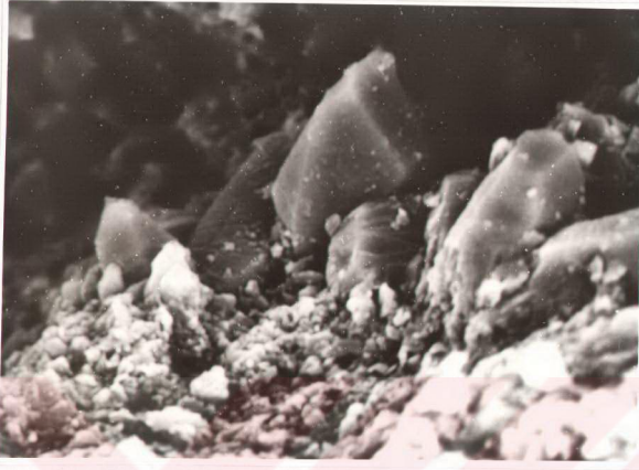
Şekil 3.36. Oolitik kireçtaşlarındaki menisküs tarzı kalsit büyümelerinin elektron mikroskopunda görünümü. Yeniçubuk Fm. Kavga Beli üyesi. Acice tepe kesiti 6 m. Acice tepe yaklaşık 1 km. D'su.
