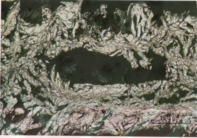
Şekil. 6.33. Keçemsi yüzeyli piritlerin mikroskopta görünümü. T.N. X 200
