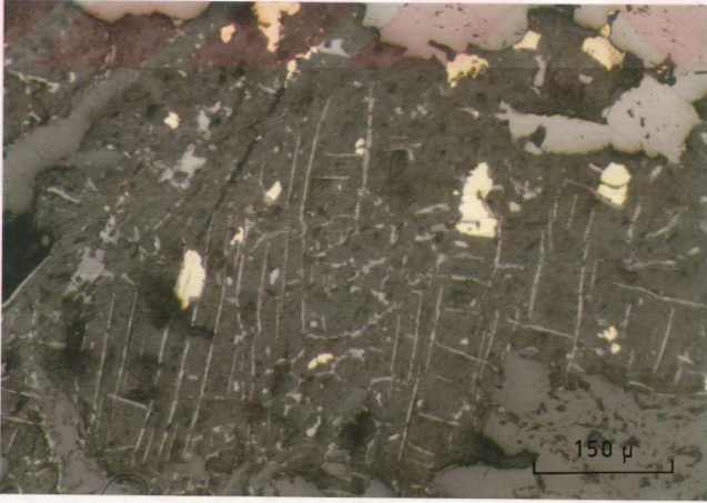
Şekil. 6.44. Ilmenit mineralindeki kafes dokusunun mikroskopta görünümü. T.N. X 200
