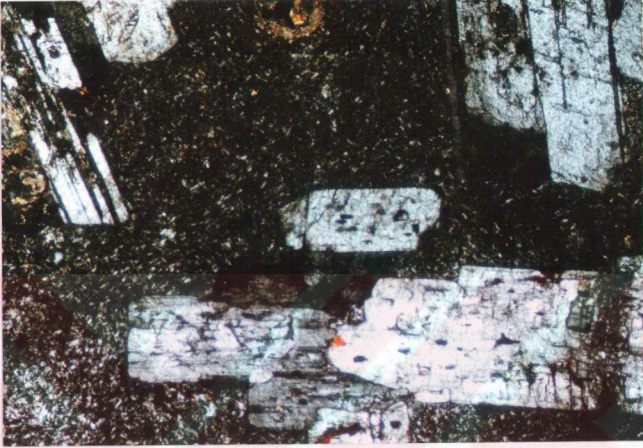
Şekil 2.13: Uzunoluk T. ve Çardaktaş T. andezitinin mikroskoptaki görünümü.İri kristaller plajiyoklaz. Çift nikol. Büyütlme : 3.2x10.
