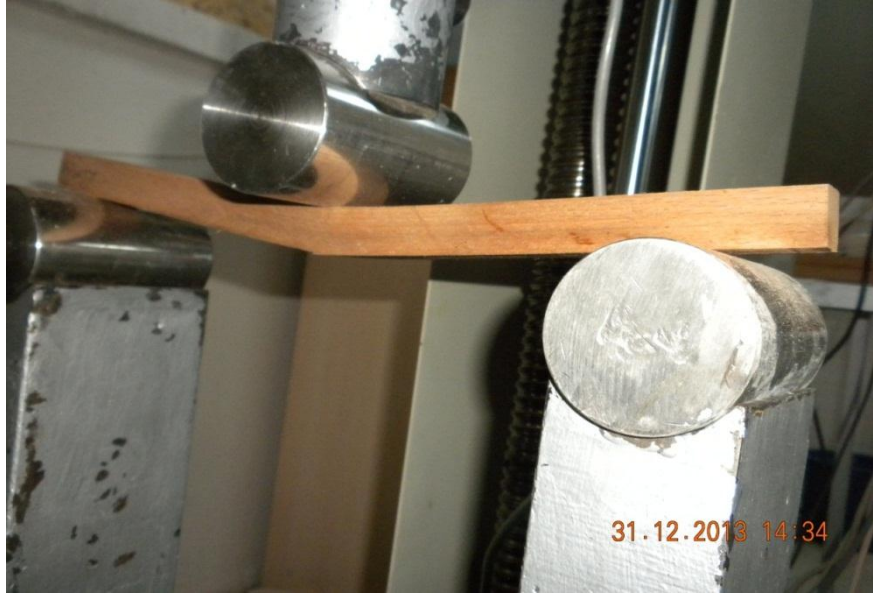
Şekil 17. Eğilme direnci testi deney uygulanması.
