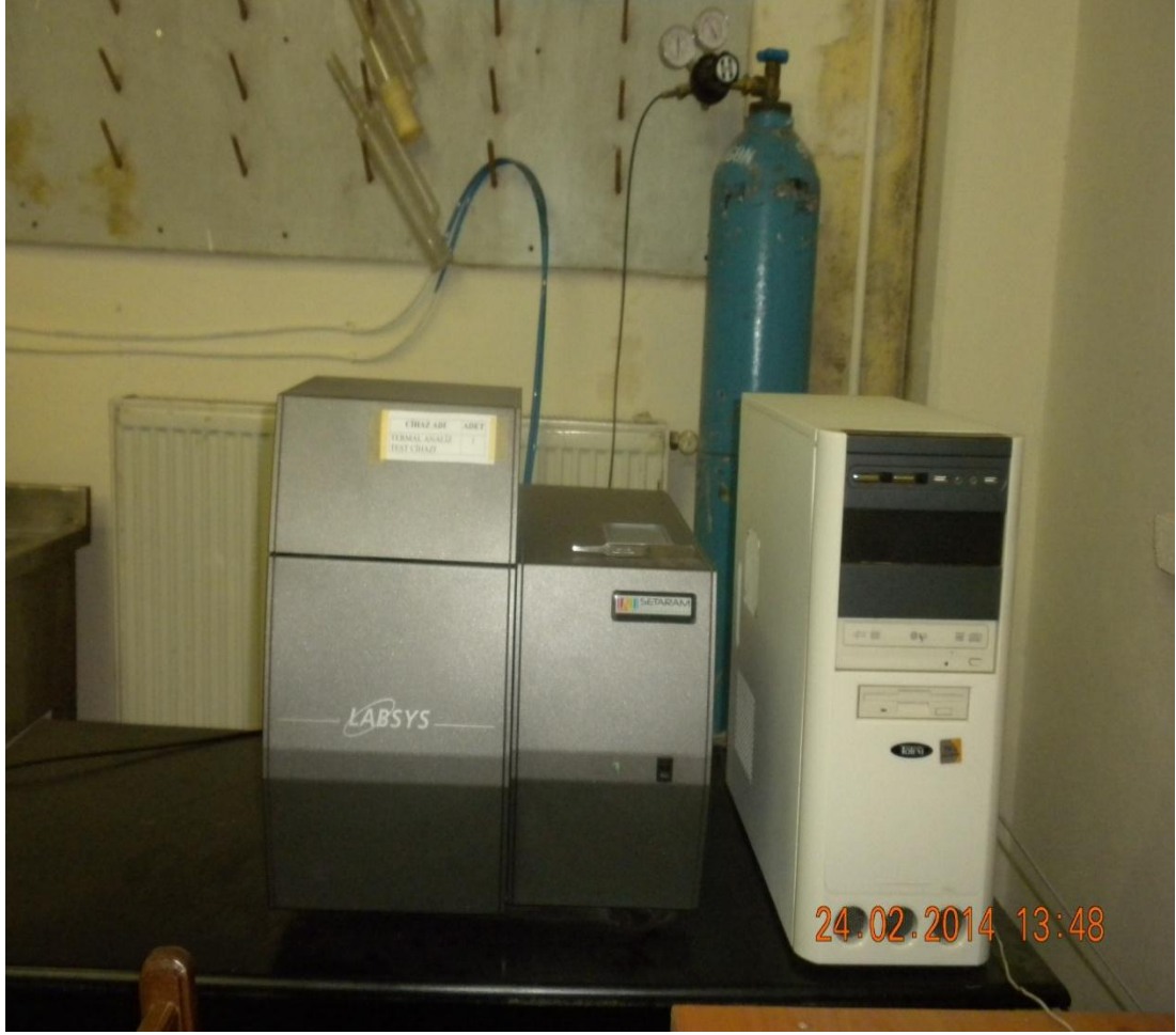
Şekil 24. LABSYS marka thermogravimetrik analizör cihazı
