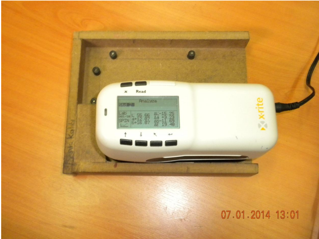
Şekil 12. Deneylerde kullanılan renk ölçüm cihazı ve ölçüm kalıbı
