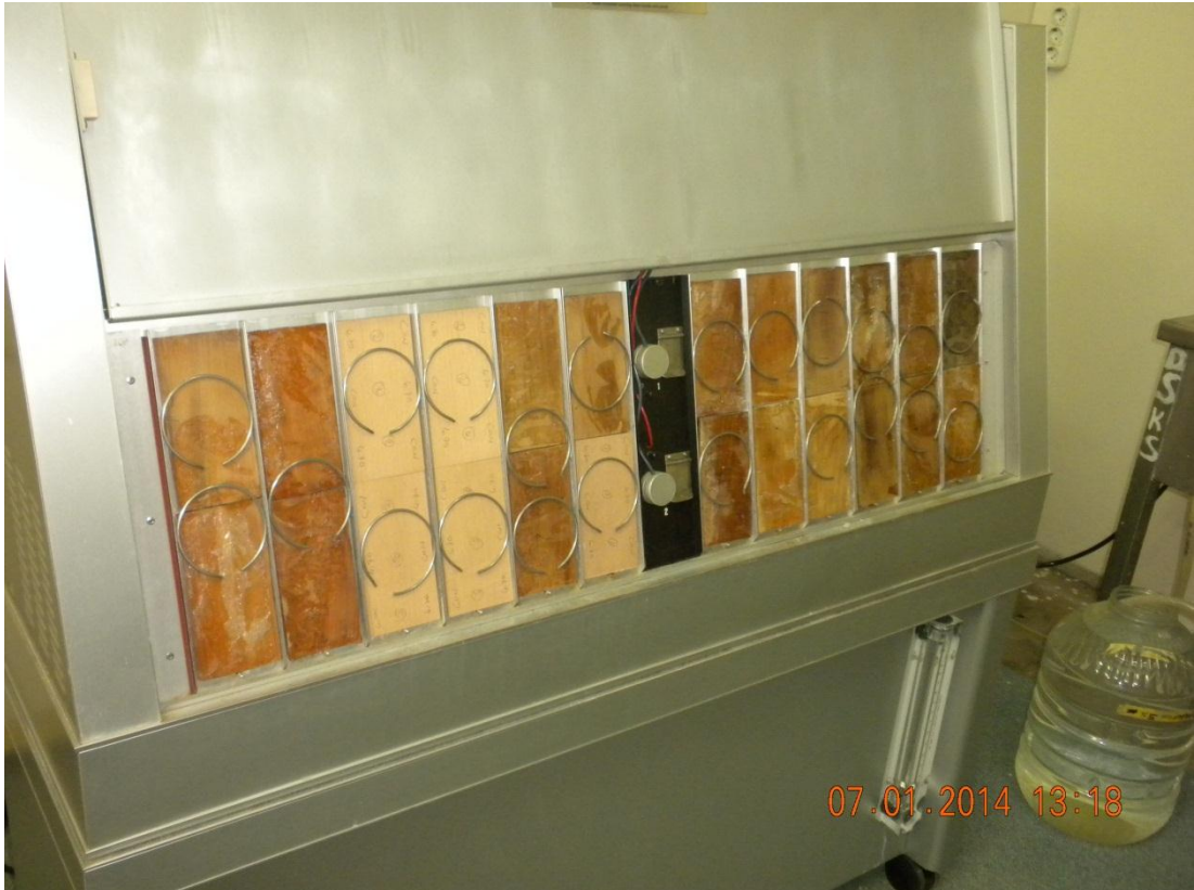
Şekil 11. Deneylerde kullanılan hızlandırılmış yaşlandırma test cihazı
