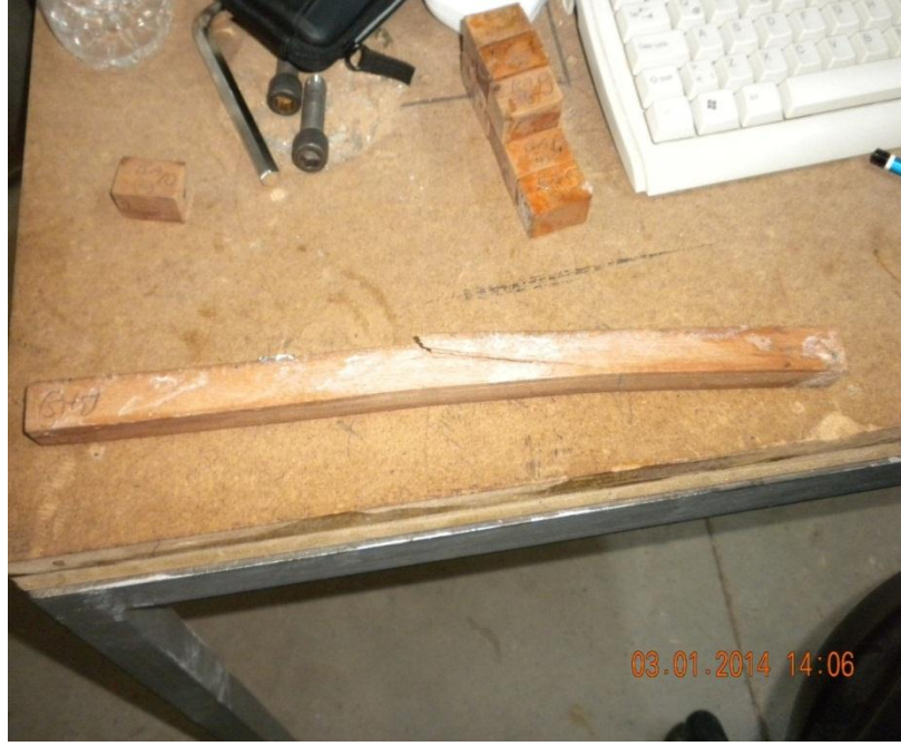
Şekil 18. Eğilme direnci testi deney uygulaması sonrası deney parçası
