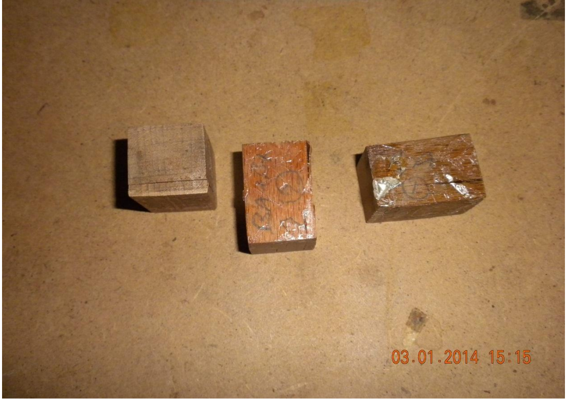
Şekil 21. Liflere paralel basınç direnci deneyinin uygulama sonrası deney örnekleri
