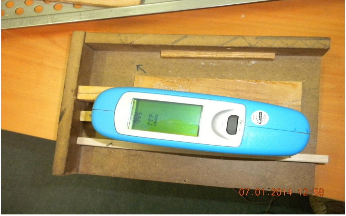
Şekil 14. Deneysel olarak kullanılan yüzey parlaklığı ölçüm cihazı
