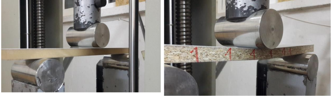
Şekil 3. 3. Eğilme deneyi testinin yapılması
