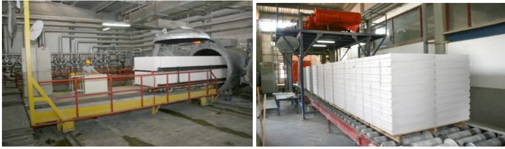
Şekil 5.5. Gazbeton Blokların Buhar Kürüne Tabi Tutulması ve Buhar Küründen Çıkanların Paketlemeye Sevk edilmesi
