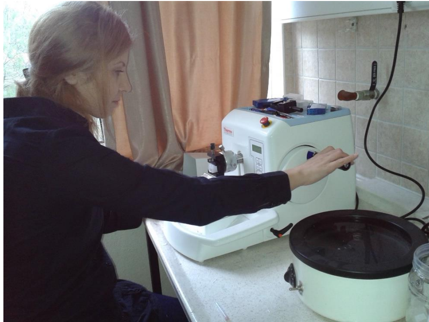
Şekil 2.14. Mikrotom cihazı ile parafin bloklardan kesit alınması
