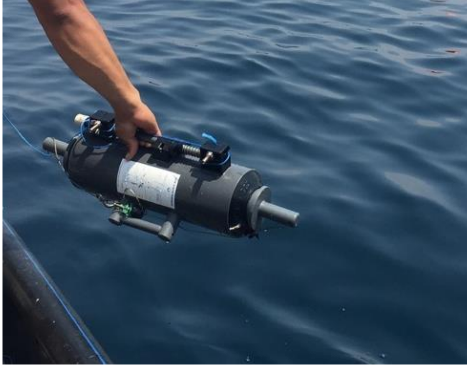
Şekil 2.6. Niskin su alma kabı ile örnekleme anı (Orijinal)
