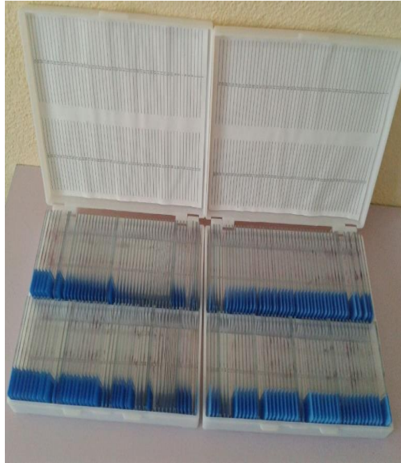
Şekil 2.15. Gonad gelişim safhalarının belirlenmesi amacıyla mikroskopta incelemeye hazır preparatlar (Doku kesiti: 4 µm, Boyama yöntemi: Hematoksilen-Eosin)
