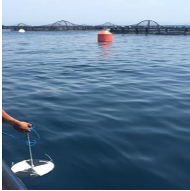
Şekil 2.7. Secchi diski derinliği ölçümü (Orjinal)
