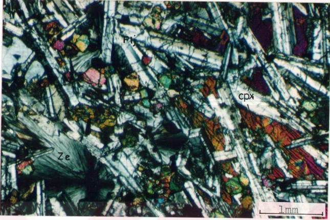
Şekil 4.6. Bazaltlarda izlenen intersertal ve ofitik dokunun mikroskopta görünümü.
