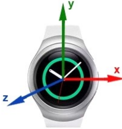
Şekil 2.4. Akıllı saat ivmeölçer algılayıcısı eksenleri
