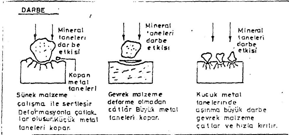
Şekil 2.4. Darbe etkisiyle abrasiv aşınma.
