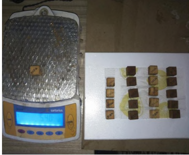
Şekil 2.18. Su alma ve su iticilik deney örnekleri
