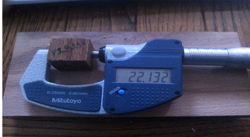
Şekil 2.19. Hacimsel ölçümlerin dijital mikrometre ile yapılması
