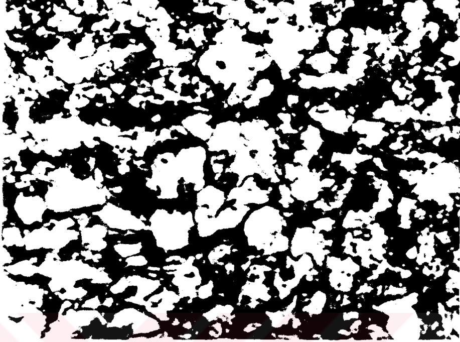
Şekil 7.25. 1.76 kJ / mm enerji girişi için ince taneli bölge. Yapı; poligonal ferrit ve perlitten oluşmaktadır. 1000 X
