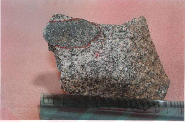
Şekil 2.23. Tonalit grubu kayalar içerisinde ana kütle ile keskin sınırlı olan MME'nin görünüşü. Örnek No: 157; Beğre-Kirlik sırtı.
