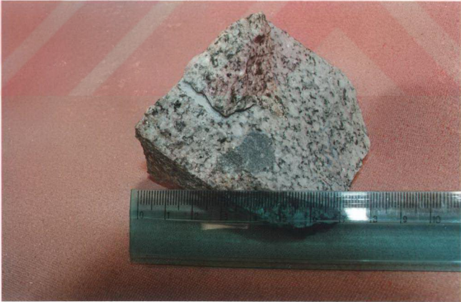
Şekil 2.22. Tonalit grubu kayalar içerisinde yer alan Mafik mikrogranüler dokulu anklavın MME) görünüşü. Örnek No: 45; Polat köyü KB'sı Kerkezin dere içi.
