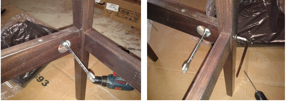
Şekil 3. 36. Sandalye arka ayak-yan kayıt montajı
