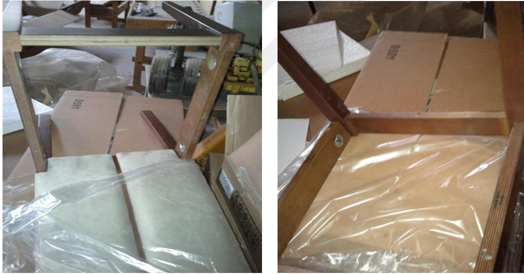
Şekil 3. 31. Sandalye oturma yeri fontu montajı
