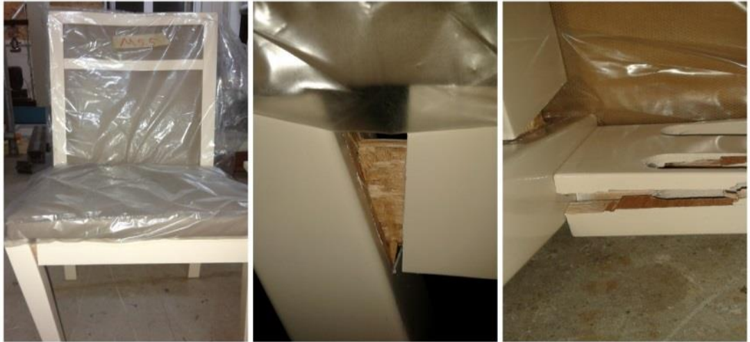
Şekil 4. 14. Yanal yükleme testinde gözlenen deformasyon biçimi
