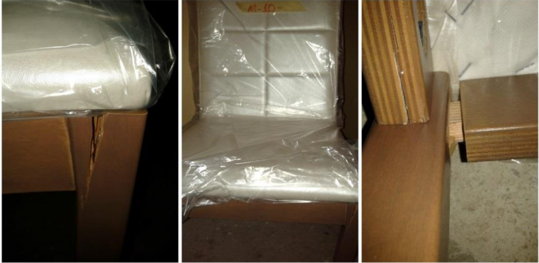
Şekil 4. 29. Yanal yükleme testinde gözlenen deformasyon biçimi
