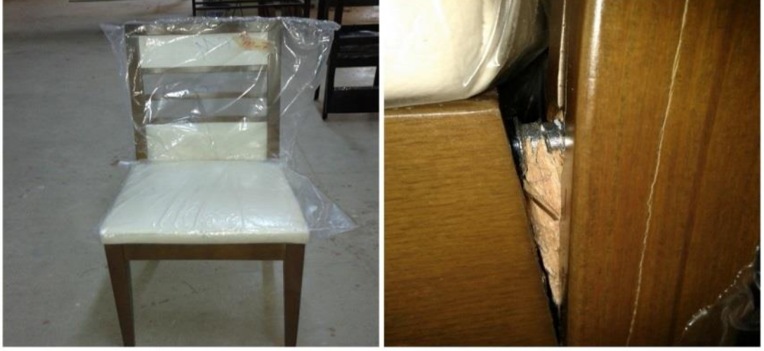
Şekil 4. 19. Önden-arkaya yükleme testinde gözlenen deformasyon biçimi
