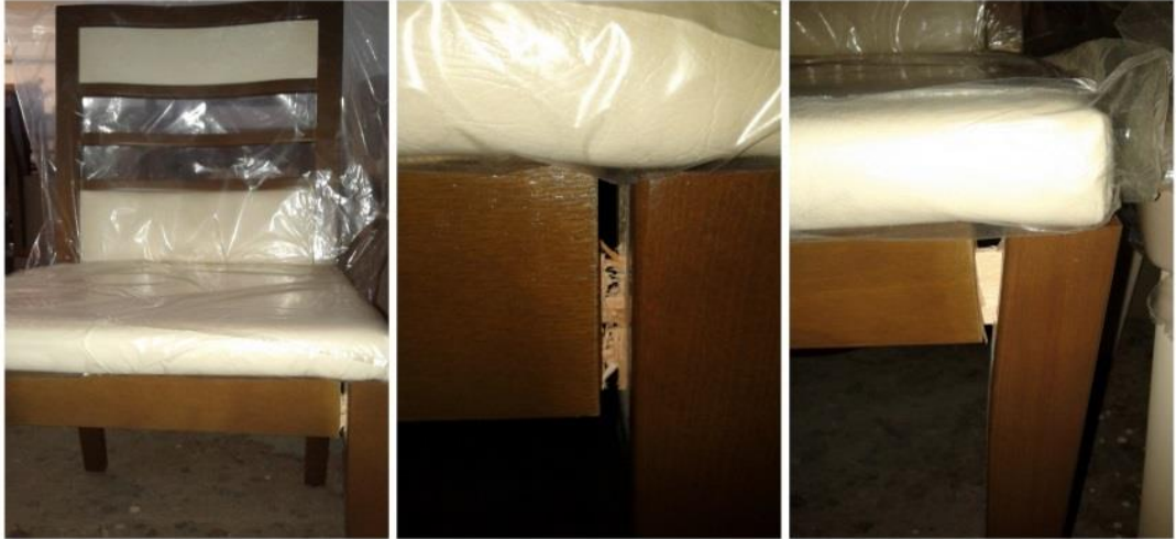
Şekil 4. 20. Yanal yükleme testinde gözlenen deformasyon biçimi
