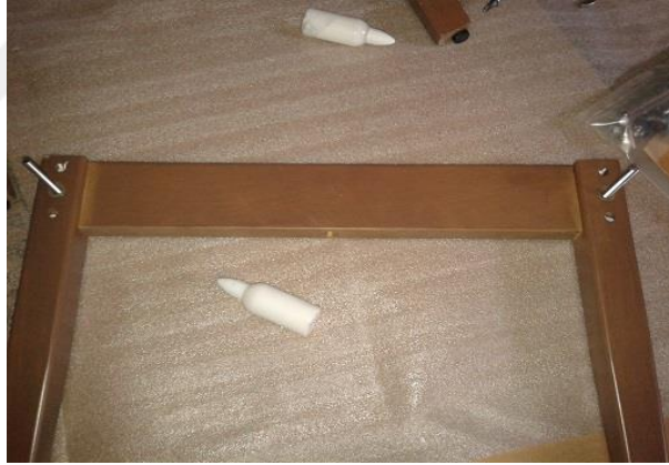
Şekil 3. 64. Sandalye ön ayak-yan kayıt montajı
