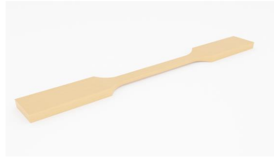
Şekil 3. 10. Çekme deneyi örnekleri (ölçüler mm'dir)
