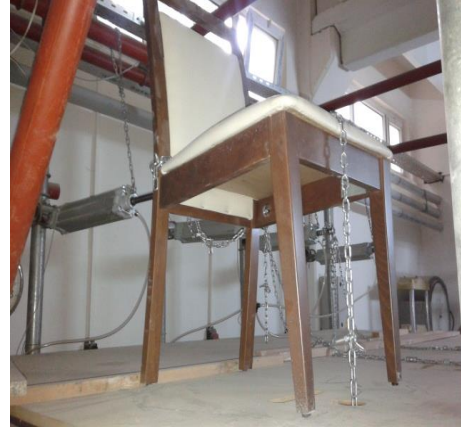
Şekil 3. 70. Önden arkaya yükleme test düzeneği ve yükleme biçimi
