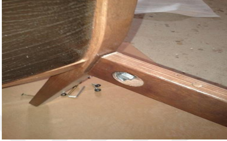
Şekil 3. 23. Sandalye oturma yeri fontu montajı
