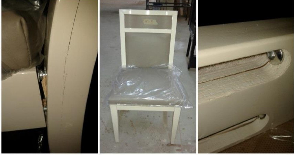
Şekil 4. 13. Önden-arkaya yükleme testinde gözlenen deformasyon biçimi
