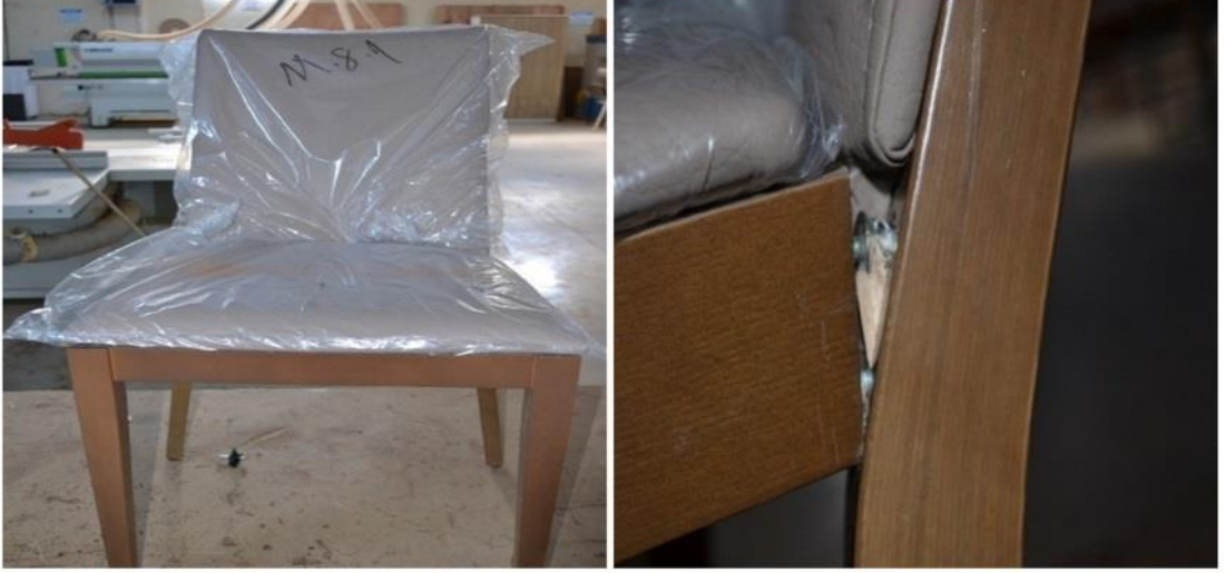
Şekil 4. 22. Önden-arkaya yükleme testinde gözlenen deformasyon biçimi
