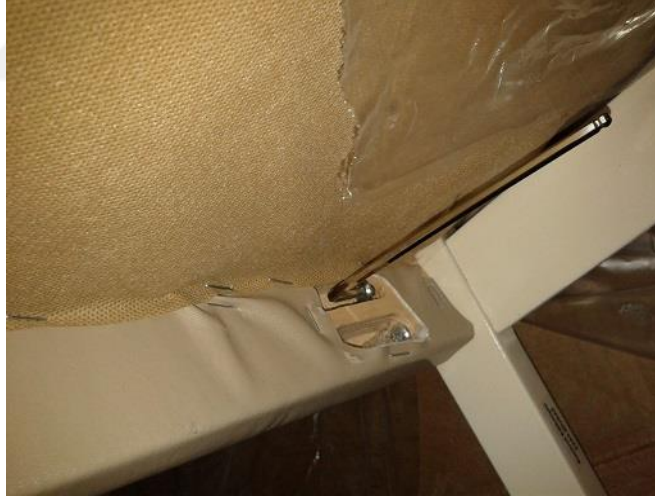
Şekil 3. 18. Sandalye oturma fontuna arka ayak montajı
