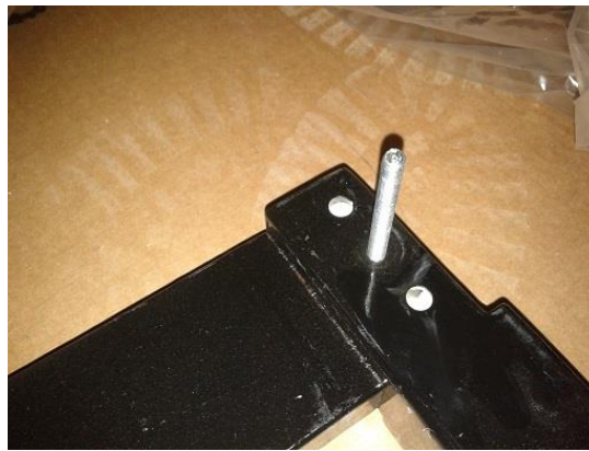
ekil 3. 59. M9 sandalye n ayak-yan kayıt montajı
