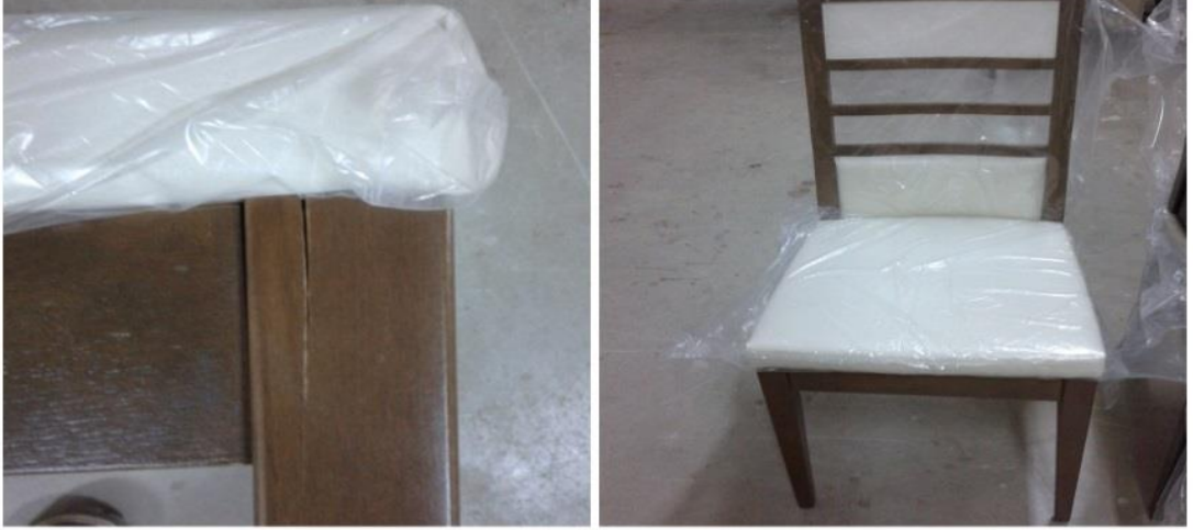
Şekil 4. 21. Arkadan-öne yükleme testinde gözlenen deformasyon biçimi
