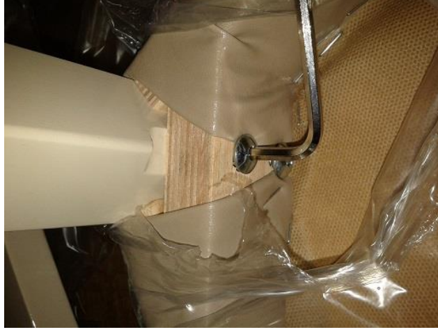
Şekil 3. 17. Sandalye oturma fontuna ön ayak montajı
