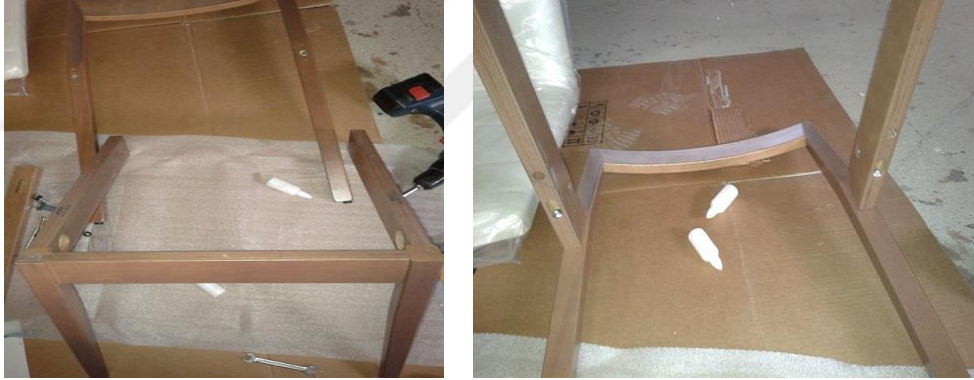
Şekil 3. 66. M10 sandalye arka ayak-yan kayıt montajı
