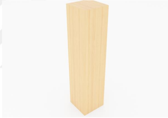
Őekil 3. 11. Liflere paralel basın direnci deneyi rnekleri (ller mm'dir)
