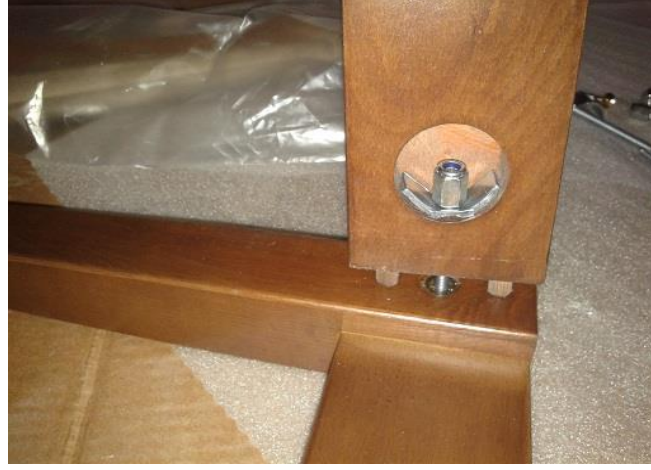
Şekil 3. 28. Sandalye arka ayak-yan kayıt montajı
