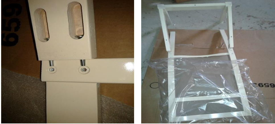
Şekil 3. 40. Sandalye ön ayak-yan kayıt, arka ayak-yan kayıt montajı
