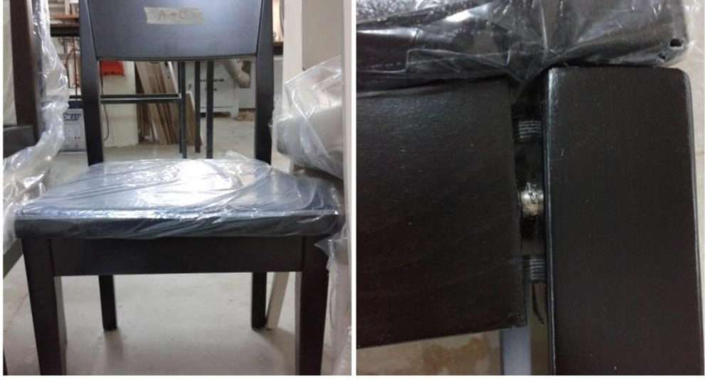
Şekil 4. 12. Arkadan-öne yükleme testinde gözlenen deformasyon biçimi
