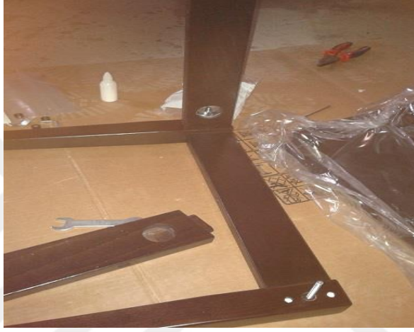
Şekil 3. 35. Sandalye ön ayak-yan kayıt montajı
