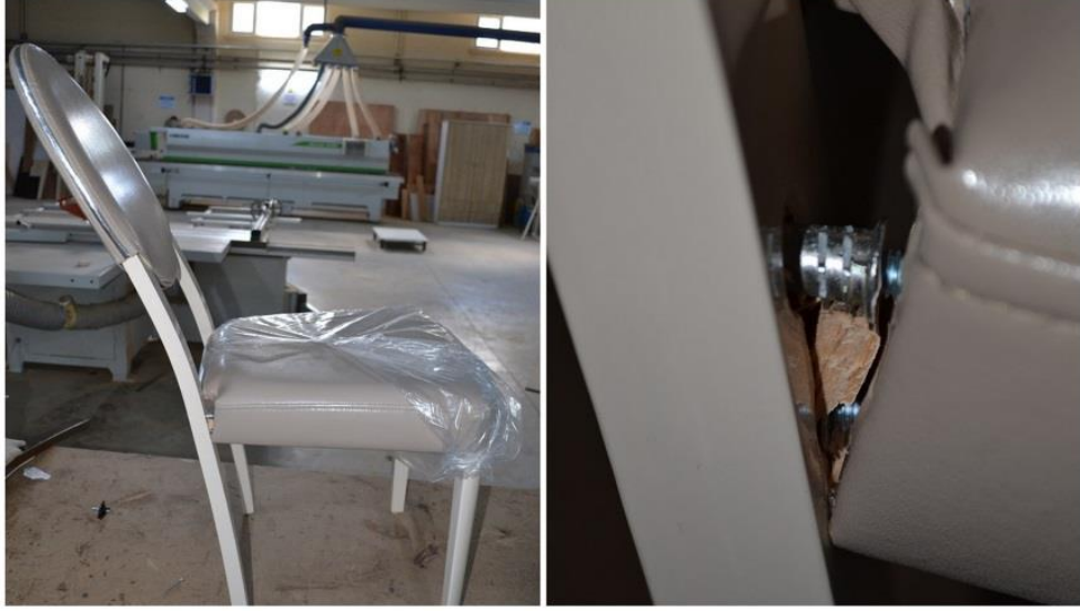
Şekil 4. 1. Önden-arkaya yükleme testinde gözlenen deformasyon biçimi
