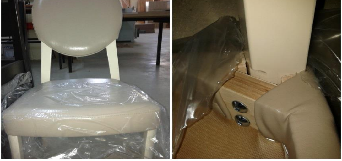
Şekil 4. 3. Arkadan-öne yükleme testinde gözlenen deformasyon biçimi
