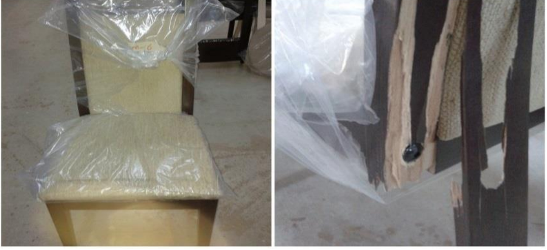
Şekil 4. 16. Önden-arkaya yükleme testinde gözlenen deformasyon biçimi
