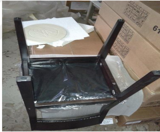
Şekil 3. 37. Sandalye oturma yeri fonu montajı
