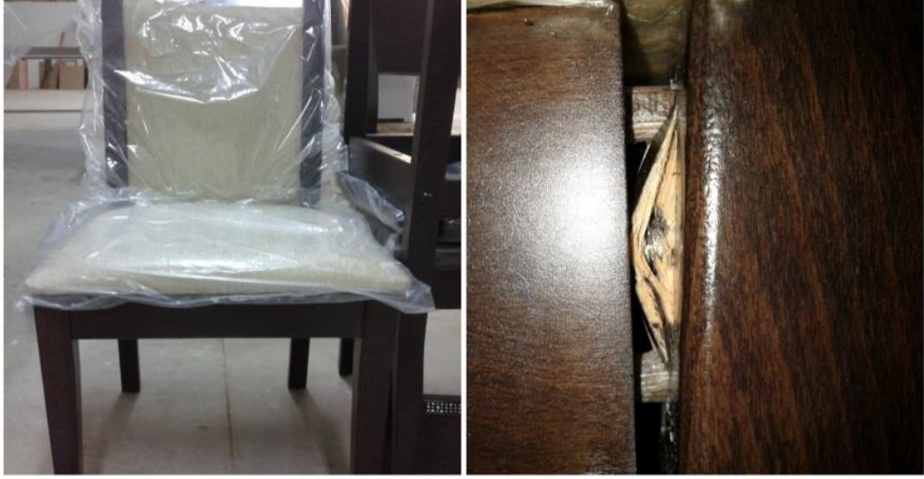
Şekil 4. 18. Arkadan-öne yükleme testinde gözlenen deformasyon biçimi
