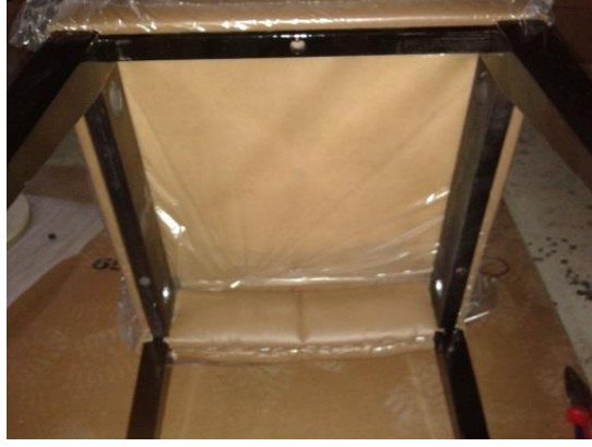
Şekil 3. 61. M9 Sandalye arka ayak-yan kayıt ve oturma yeri fontu montajı
