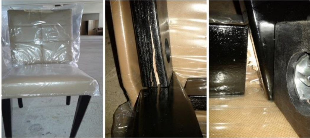
Şekil 4. 26. Yanal yükleme testinde gözlenen deformasyon biçimi
