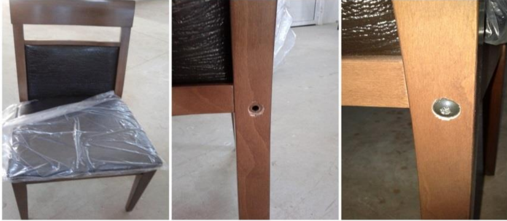
Şekil 4. 4. Önden-arkaya yükleme testinde gözlenen deformasyon biçimi
