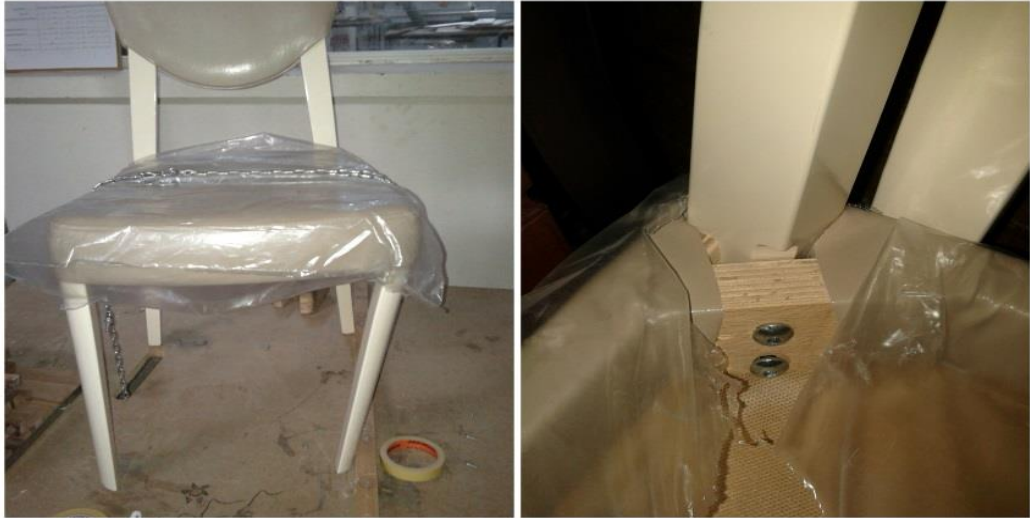
Şekil 4. 2. Yanal yükleme testinde gözlenen deformasyon biçimi
