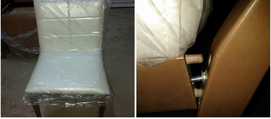
Şekil 4. 28. Önden-arkaya yükleme testinde gözlenen deformasyon biçimi
