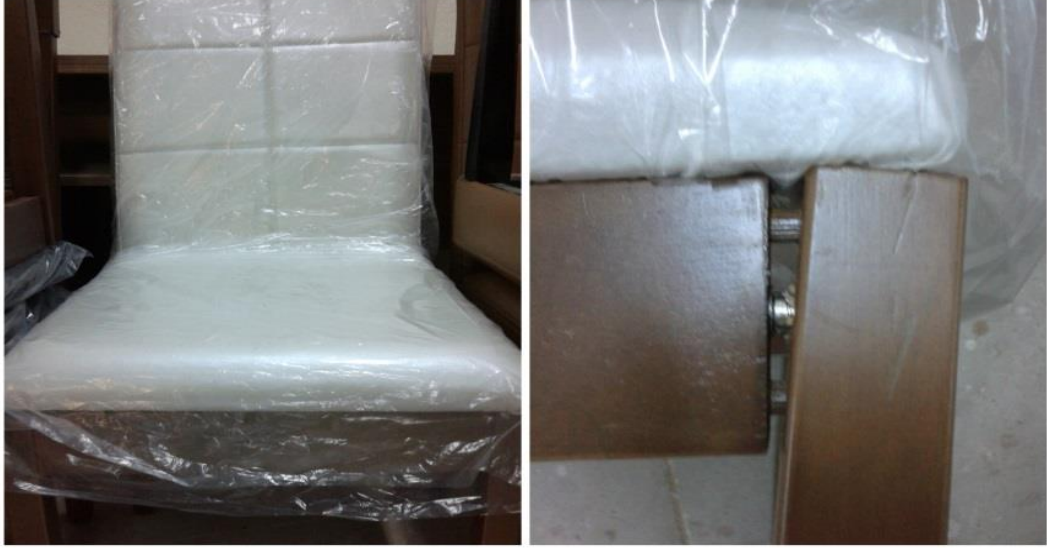
Şekil 4. 30. Arkadan-öne yükleme testinde gözlenen deformasyon biçimi
