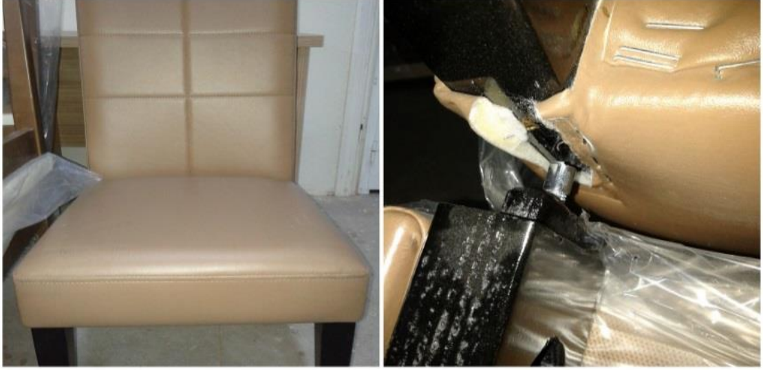
Şekil 4. 25. Önden-arkaya yükleme testinde gözlenen deformasyon biçimi
