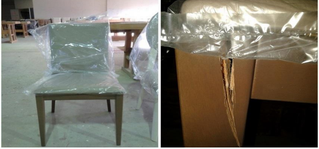
Şekil 4. 24. Arkadan-öne yükleme testinde gözlenen deformasyon biçimi
