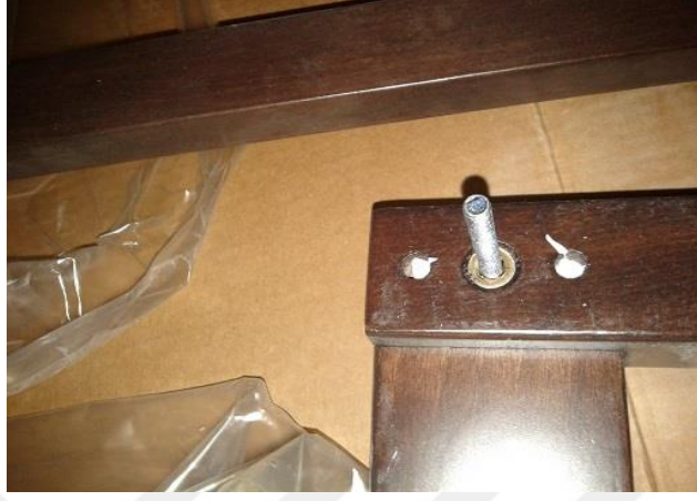
Şekil 3. 44. Sandalye ön ayak-yan kayıt montajı
