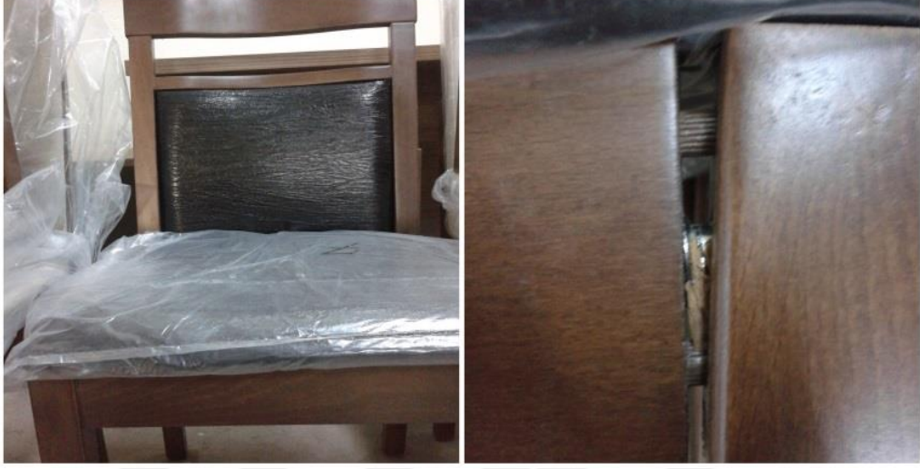
Şekil 4. 6. Arkadan-öne yükleme testinde gözlenen deformasyon biçimi
