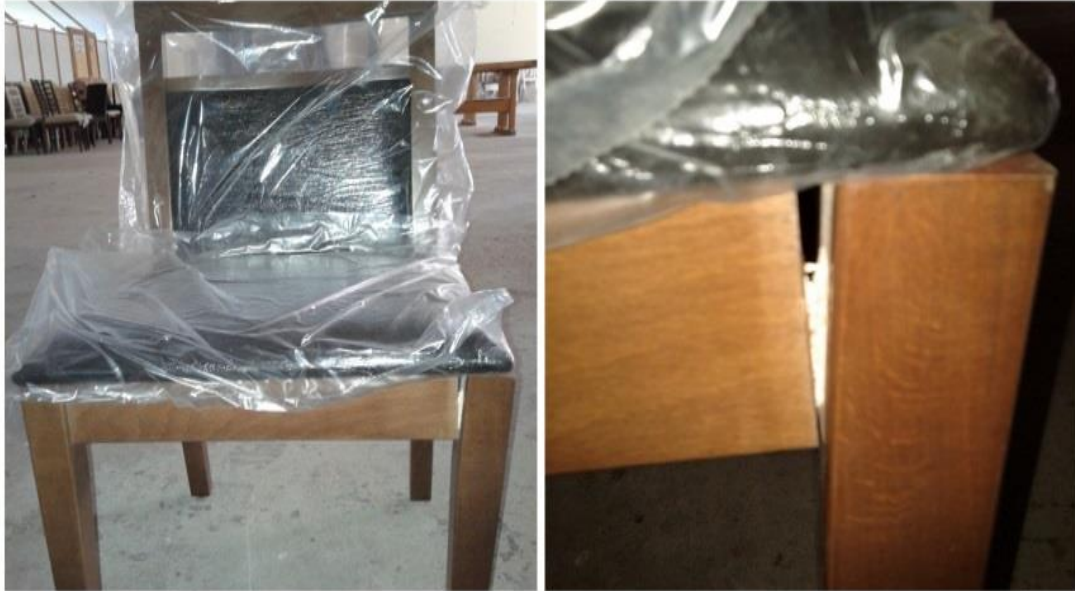
Şekil 4. 5. Yanal yükleme testinde gözlenen deformasyon biçimi
