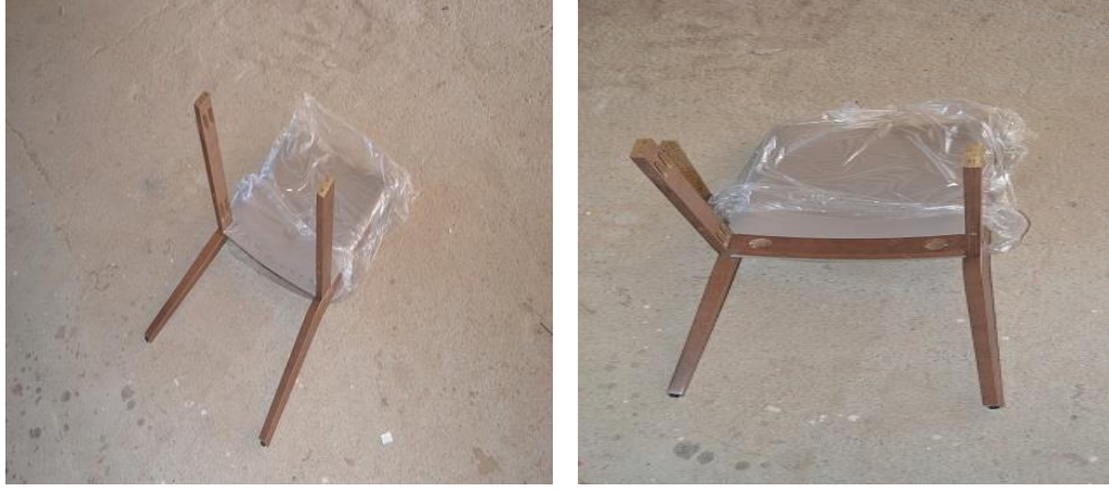
Şekil 3. 55. Sandalye arka ayak-yan kayıt montajı
