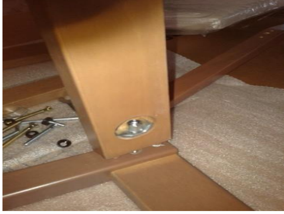
Şekil 3. 65. M10 sandalye ön ayak-yan kayıt montajı
