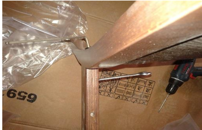
Şekil 3. 24. Sandalye oturma yeri fontu montajı
