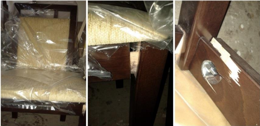
Şekil 4. 17. Yanal yükleme testinde gözlenen deformasyon biçimi
