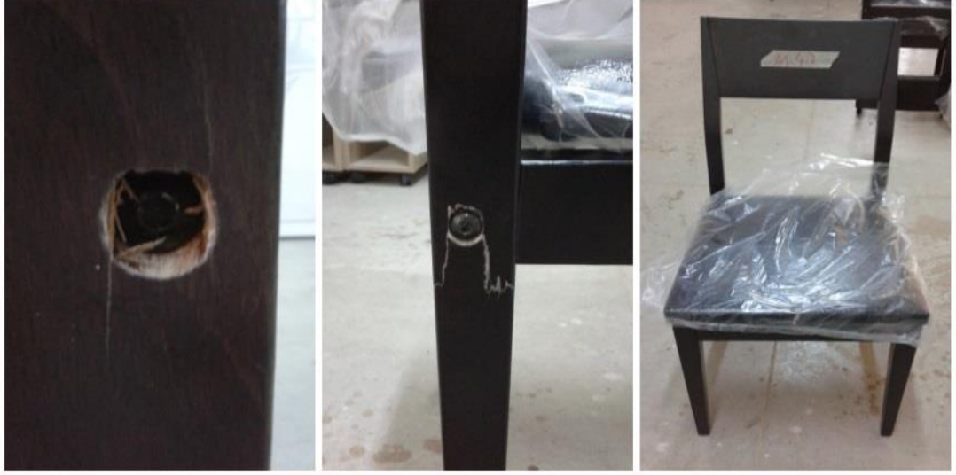
Şekil 4. 10. Önden-arkaya yükleme testinde gözlenen deformasyon biçimi
