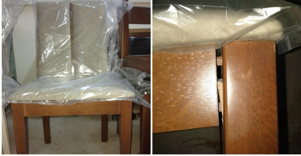
Şekil 4. 9. Arkadan-öne yükleme testinde gözlenen deformasyon biçimi
