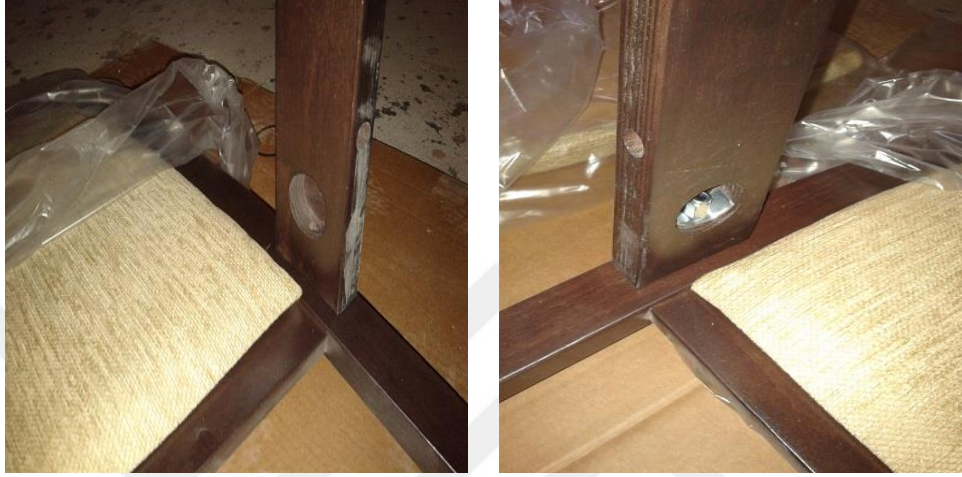
Şekil 3. 46. Sandalye arka ayak-yan kayıt montajı
