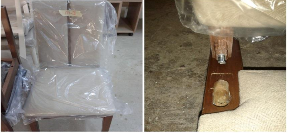
Şekil 4. 7. Önden-arkaya yükleme testinde gözlenen deformasyon biçimi
