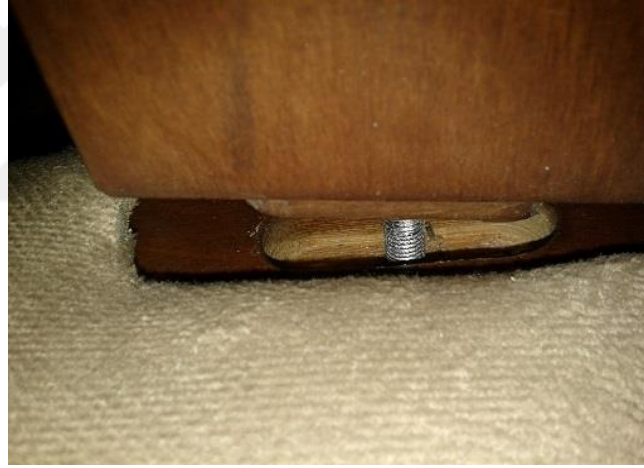
Şekil 3. 29. Sandalye arka ayak-yan kayıt montajı
