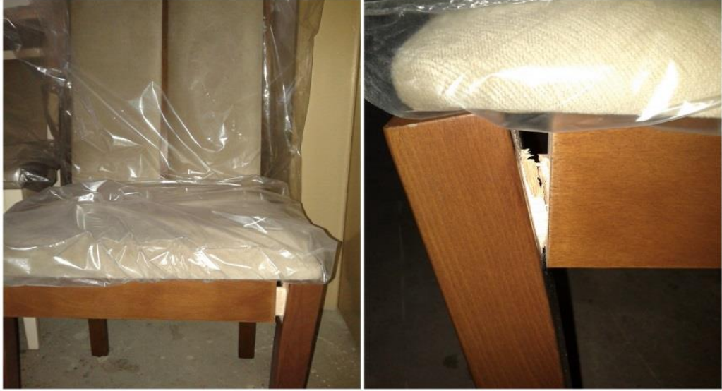
Şekil 4. 8. Yanal yükleme testinde gözlenen deformasyon biçimi
