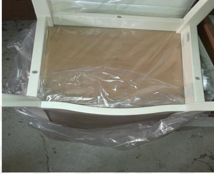
Şekil 3. 41. Sandalye oturma yeri fonu montajı
