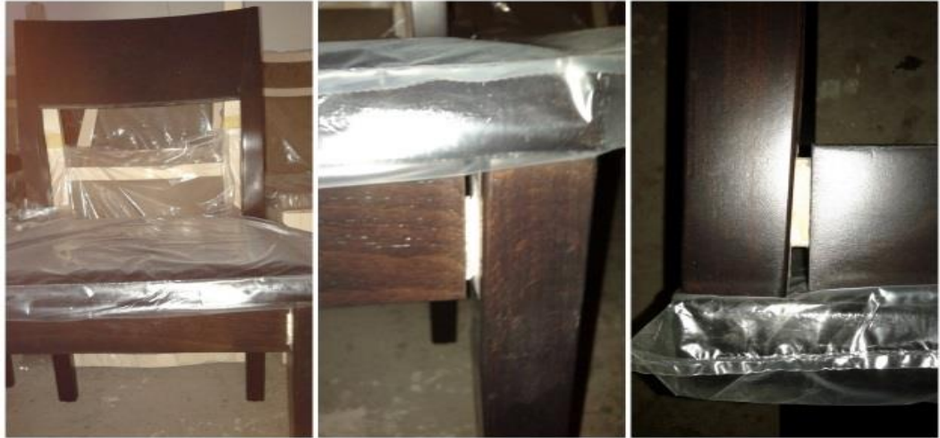
Şekil 4. 11. Yanal yükleme testinde gözlenen deformasyon biçimi
