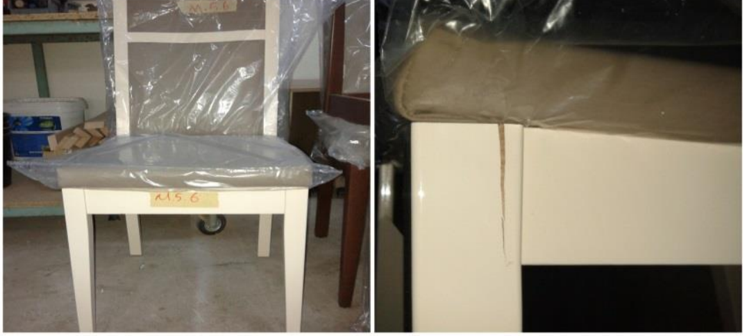
Şekil 4. 15. Arkadan-öne yükleme testinde gözlenen deformasyon biçimi
