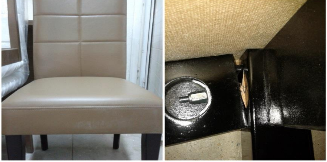
Şekil 4. 27. Arkadan-öne yükleme testinde gözlenen deformasyon biçimi
