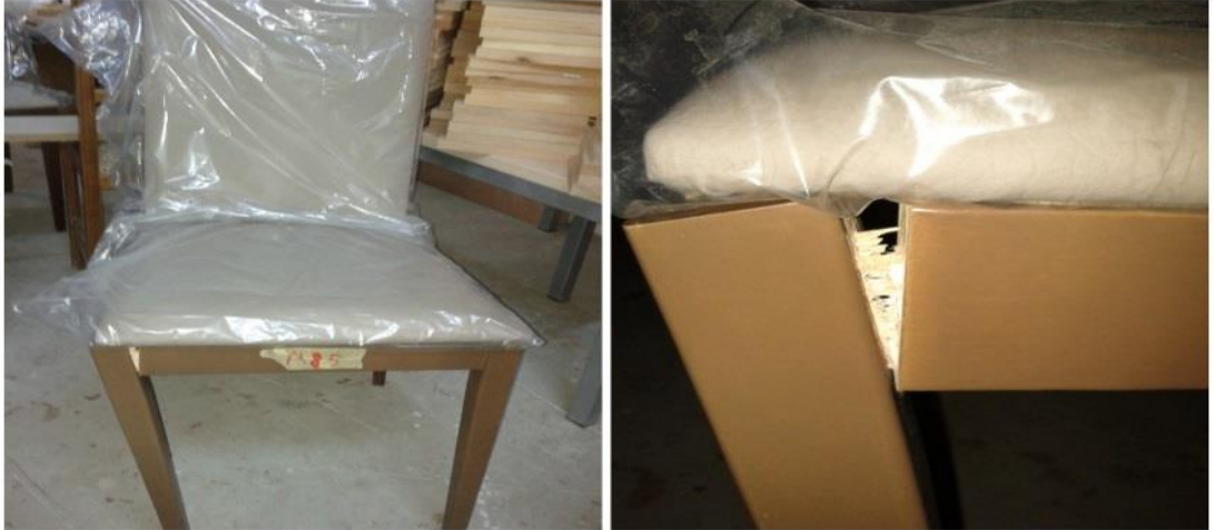
Şekil 4. 23. Yanal yükleme testinde gözlenen deformasyon biçimi
