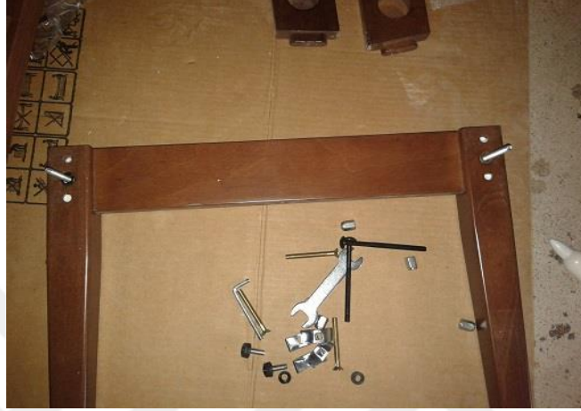
Şekil 3. 27. Ön ayak-yan kayıt montajı
