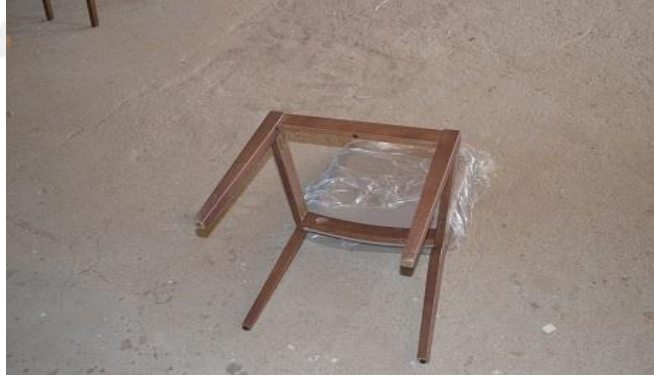
Şekil 3. 56. Sandalye oturma yeri fontu montajı
