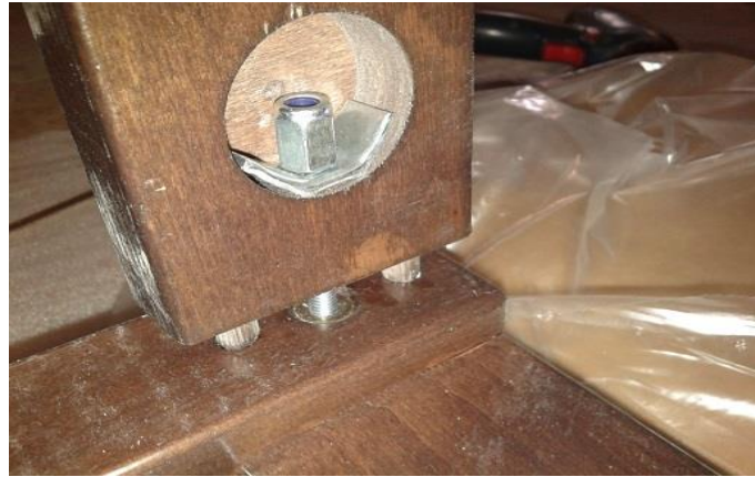
Şekil 3. 45. Sandalye ön ayak-yan kayıt montajı
