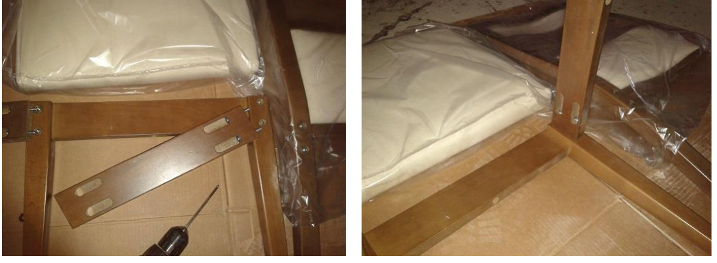
Şekil 3. 51. Sandalye ön ayak-yan kayıt montajı
