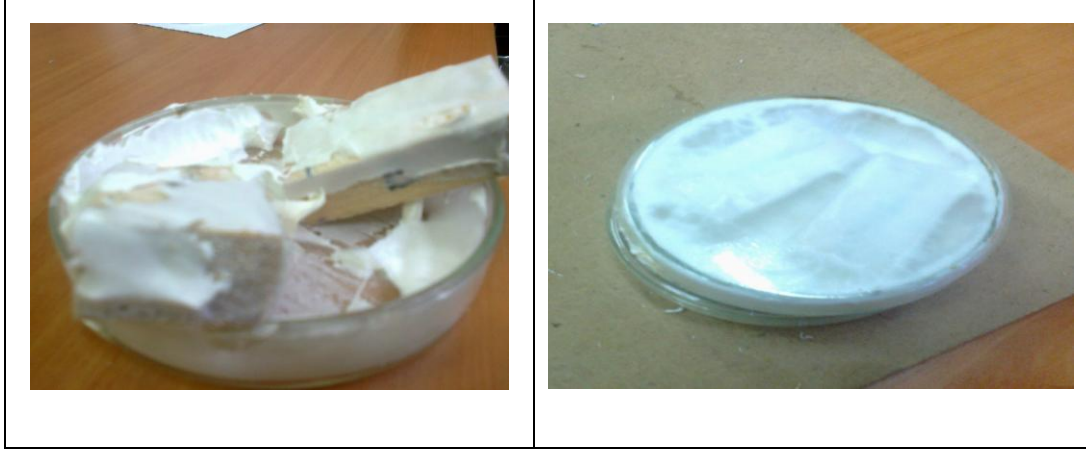
Şekil 22. Test örneklerinin petri kaplarından ölçüm için çıkarılması
