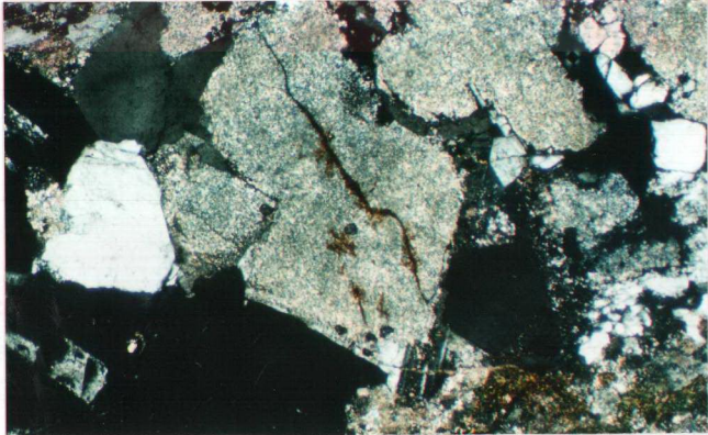
Şekil 3.8: Yan kayalarda alterasyon sonucu gelişen serizitleşmeler. NS-2 sondajı, metraj: 108.80 m (ÇN X 32).
