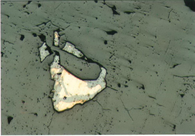
Şekil 3.3: Kayaçtaki hidrotermal alterasyon ile gelişmiş, kalkopiritten (açık sarı) limonit (açık gri) dönüşümleri. NS-4 sondajı, metraj: 38.50 m. (ÇN X 100).
