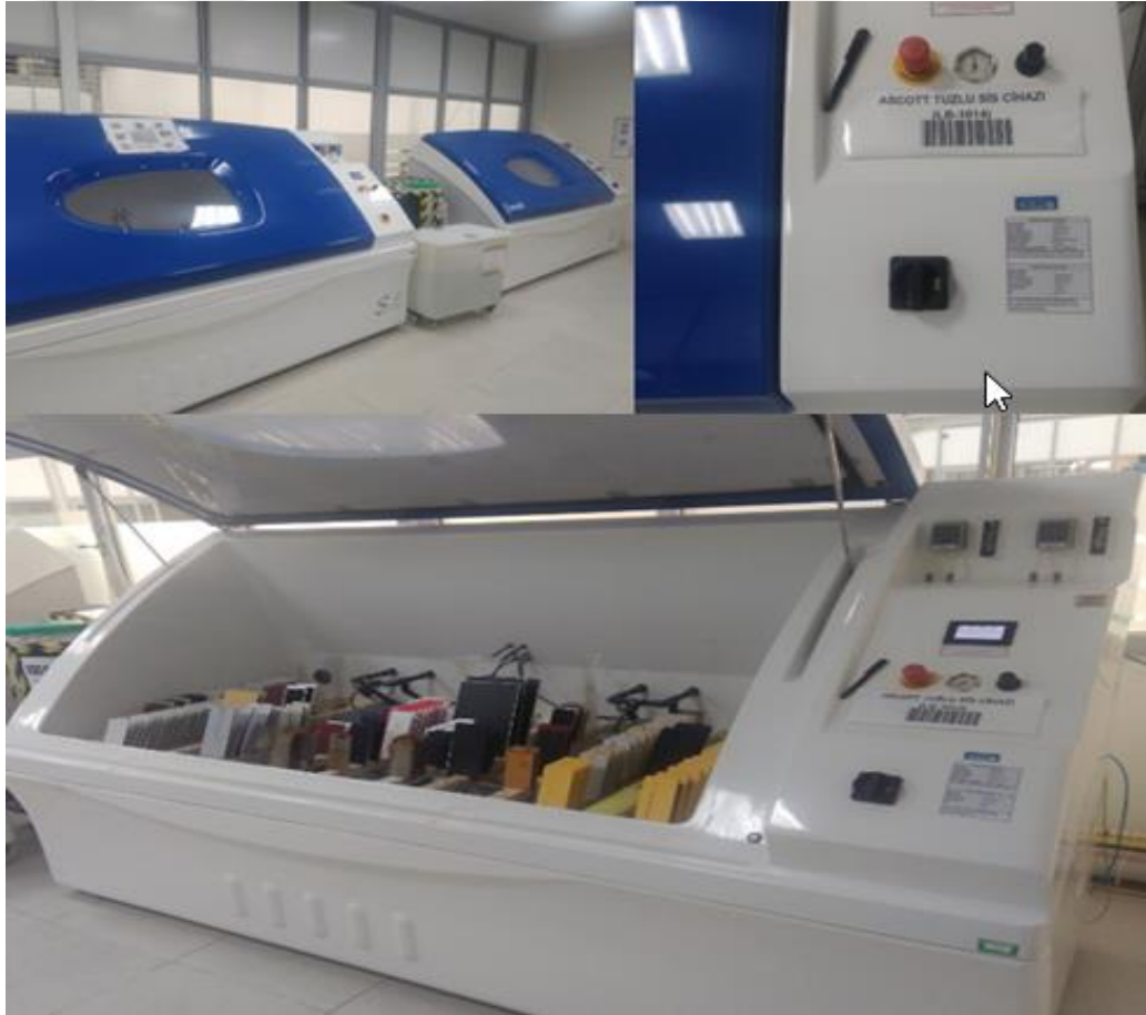
Şekil 3.20. Tuzlu su sisi testinin yapıldığı cihaz
