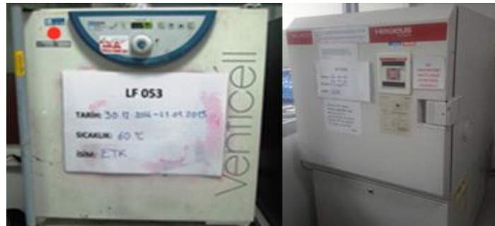
Şekil 3.19. Sıcak-soğuk şok testinin yapıldığı iklimlendirme cihazı ve fırını
