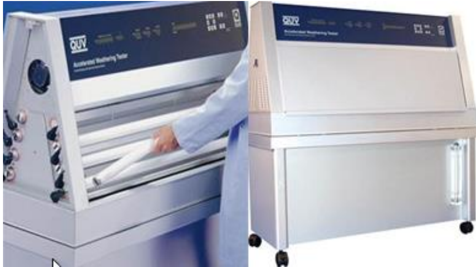
Şekil 3.13. Hızlı yaşlandırma test cihazı
