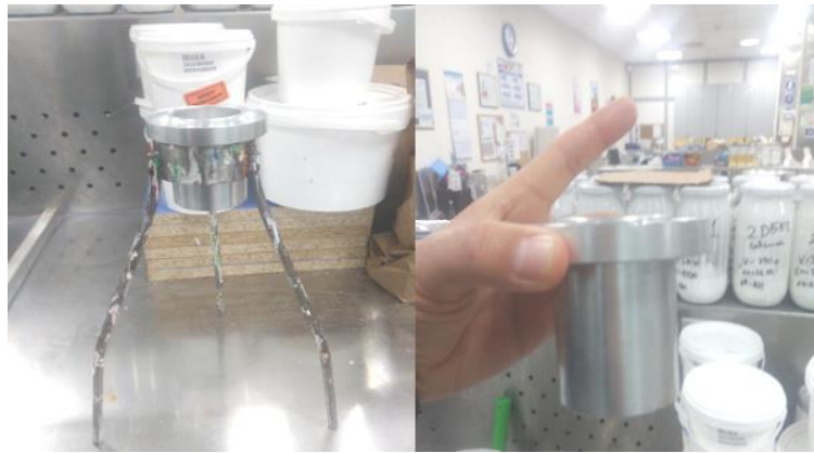
Şekil 3.11. Viskozite ölçümü için kullanılan çapı 4 mm olan DIN kabı
