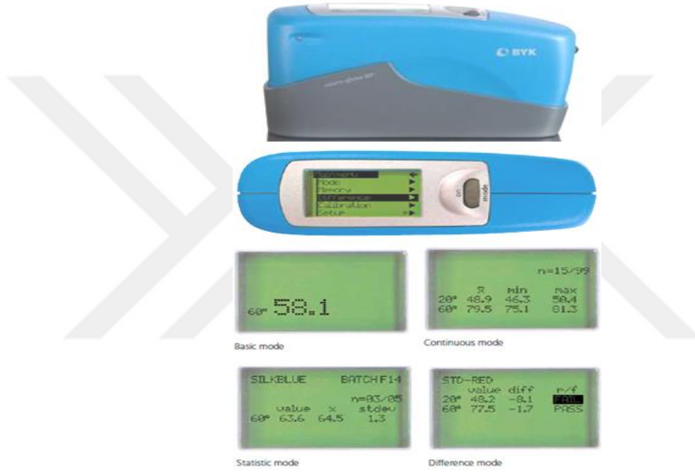
Şekil 3.18. BYK Gardner parlaklık ölçümü cihazı
