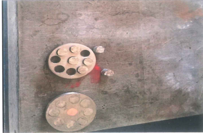
Şekil 3.1.(c) Ni ve Cu hedeflerin yerleştirilmesi
