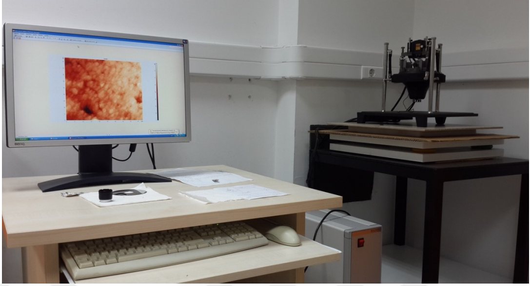
Şekil 4.4. Atomik Kuvvet Mikroskobu (AKM)
