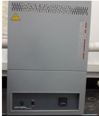
Şekil 4. 2. Toz halinde bileşik, Pres makinesi ile tablet basımı , Yüksek sıcaklık ısıtma fırını (1000°C)
