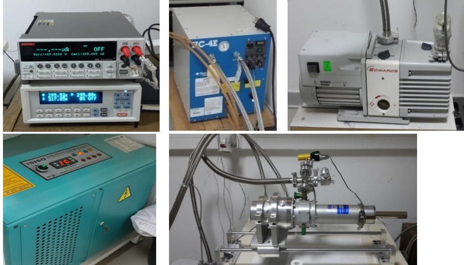
Şekil 4.10. Düşük Sıcaklık Direnç Ölçüm Sistem üniteleri; a) Keithley 2400 Akım kaynağı ve Lake Shore sıcaklık kontrol sistemi b) Helyum kompresör c) Edwards vakum pompası d) Isıso kompakt mini soğutucu ünitesi e) Kryostat örnek tutucu
