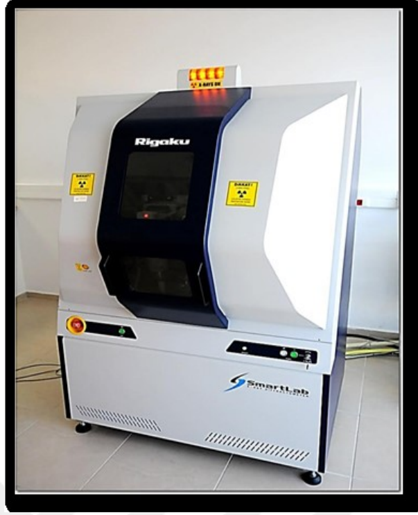
Şekil 4.9 Rigaku marka Smart Lab. model X-ışını toz kırınım cihazı
