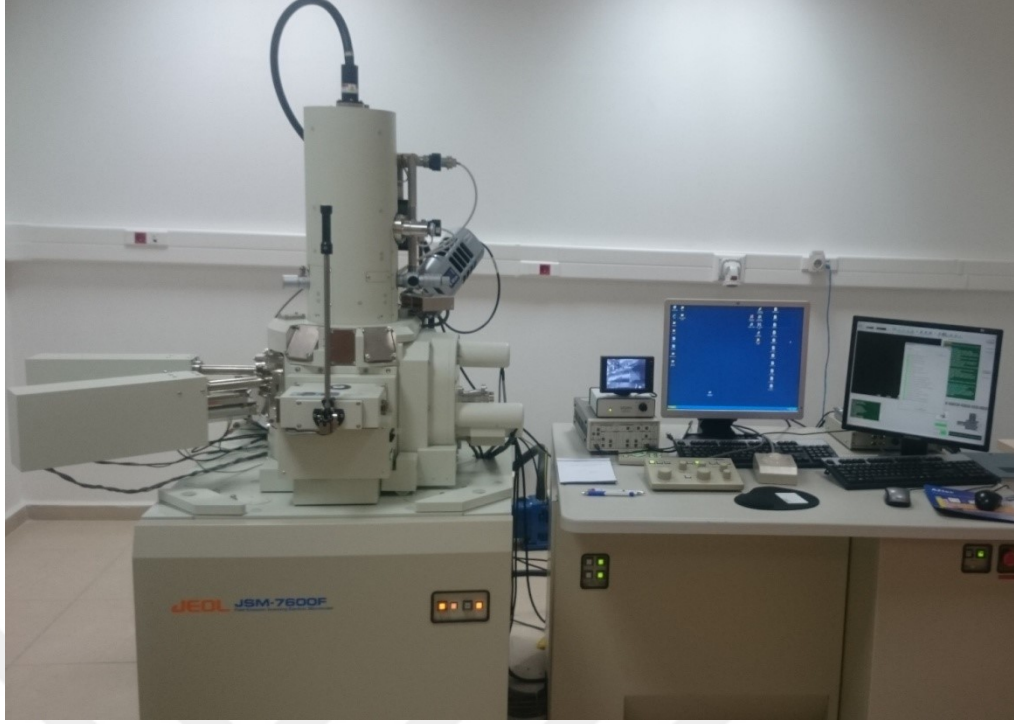
Şekil 4.6. “JEOL, JSM-7600 F” marka ve model SEM cihazı
