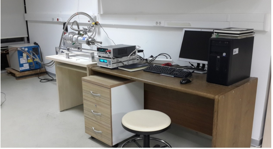
Şekil 4.13. Düşük Sıcaklık Direnç Ölçüm sistemi (Man. Malz. Lab. Muğla S. K. Üniv.)
