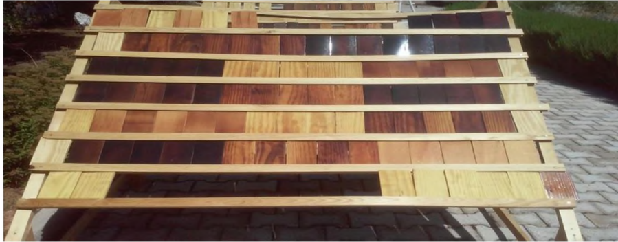
Şekil 2.4. Doğal yaşlandırmaya bırakılan deney örnekleri
