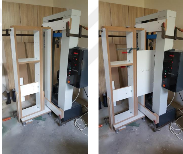
Şekil 4.17. Kapak boyu 80 cm olan kapaklar için hazırlanan platform
