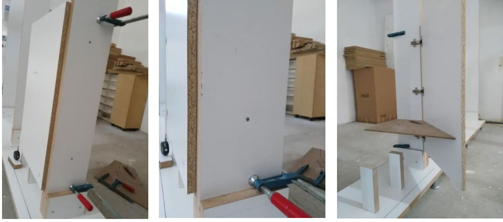
Şekil 4.21. Gövde parçasının platforma bağlantısı
