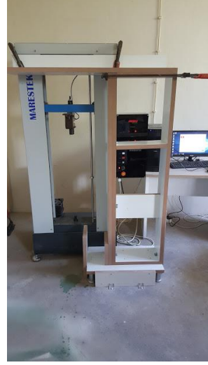
Şekil 4.18. Kapak boyu 100 ve 120 cm olan kapaklar için hazırlanan platform
