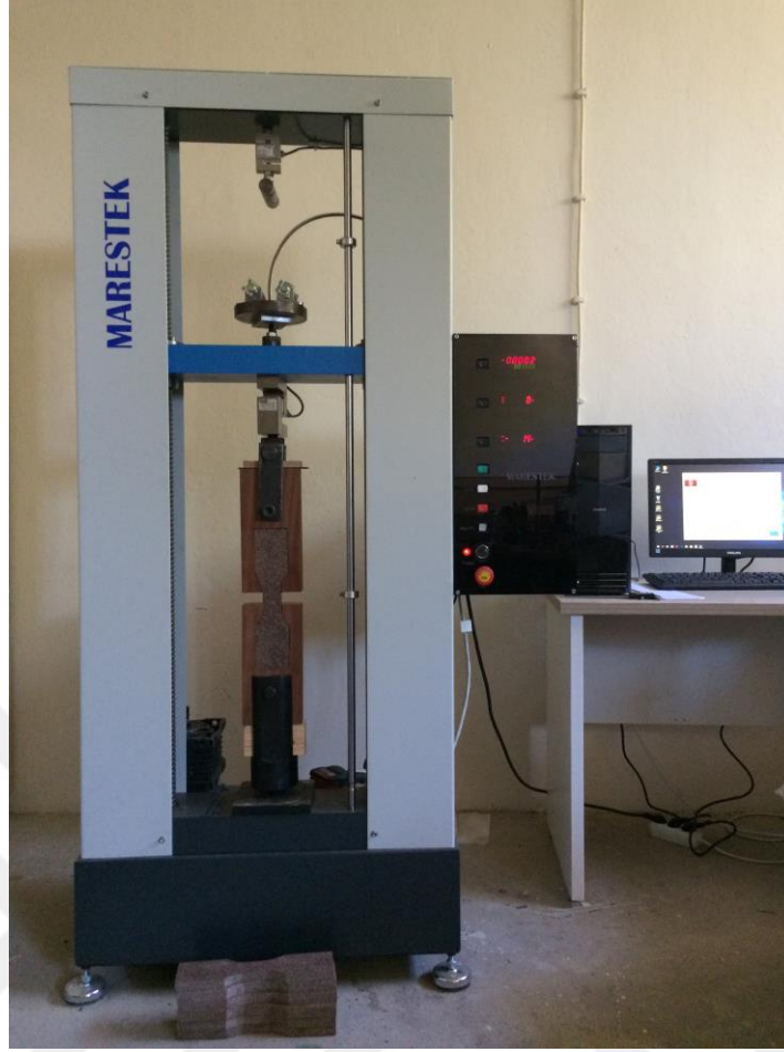
Şekil 3.15. Çekme testi yapılışı
