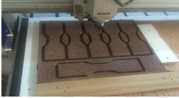
Şekil 3.7. CNC makinesinde APK numune hazırlanması
