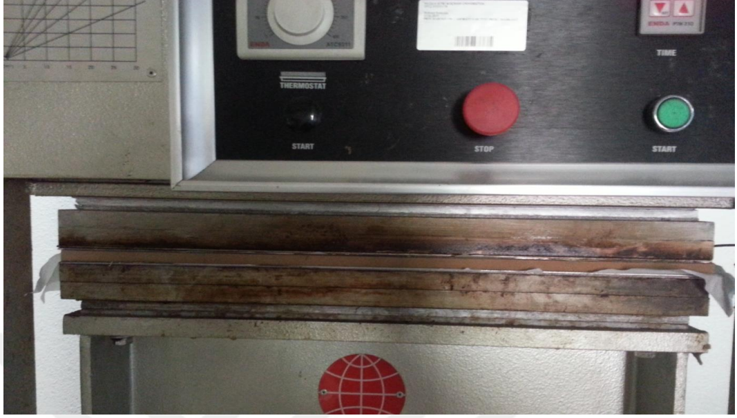
Şekil 3.5. APK karışımının preslenmesi
