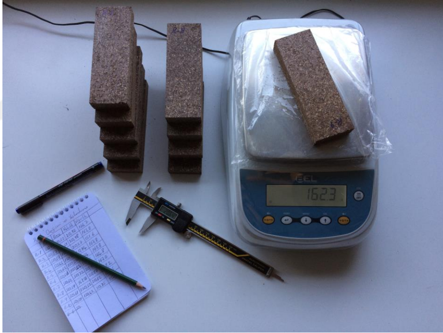
Şekil 3.30. APK doğal yaşlandırma numuneleri
