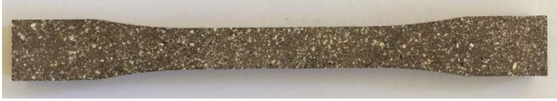
Şekil 3.12. Çekme testi numune örneği (ASTM D 638-99)
