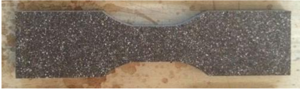
Şekil 3.14. Çekme testi numune örneği (ASTM D 1037)
