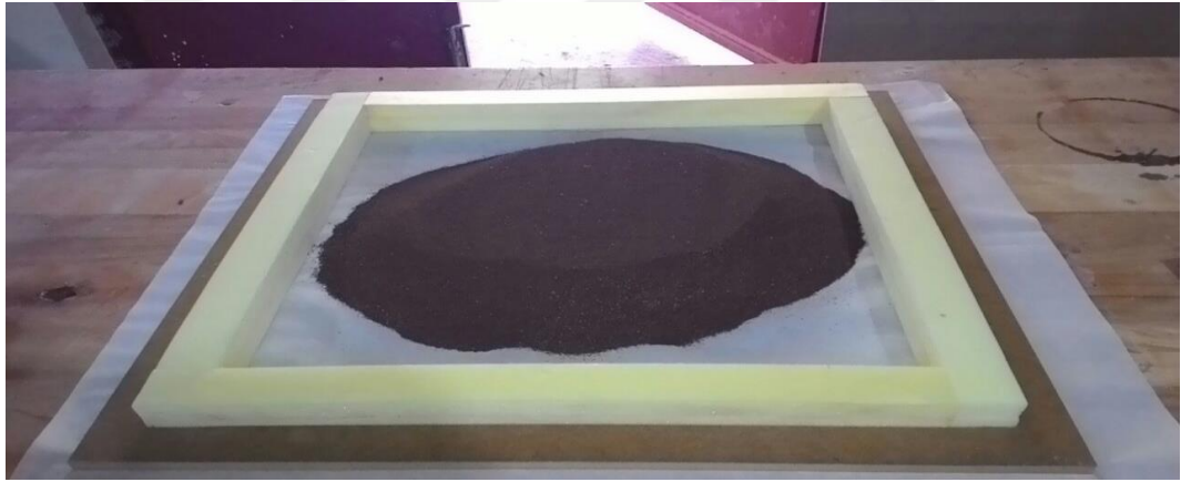
Şekil 3.2. APK karışımının kalıba dökülmesi
