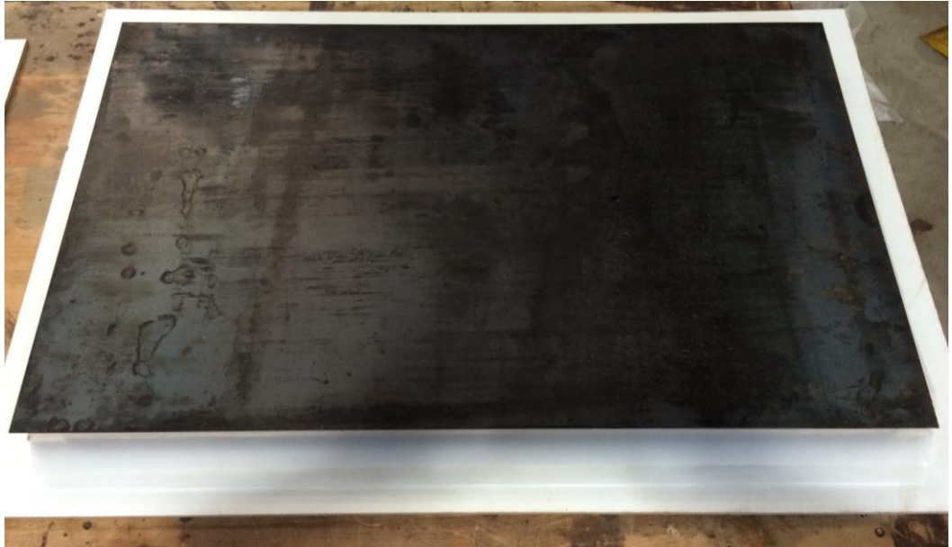
Şekil 3.4. APK'nın kalıpta prese hazırlanması
