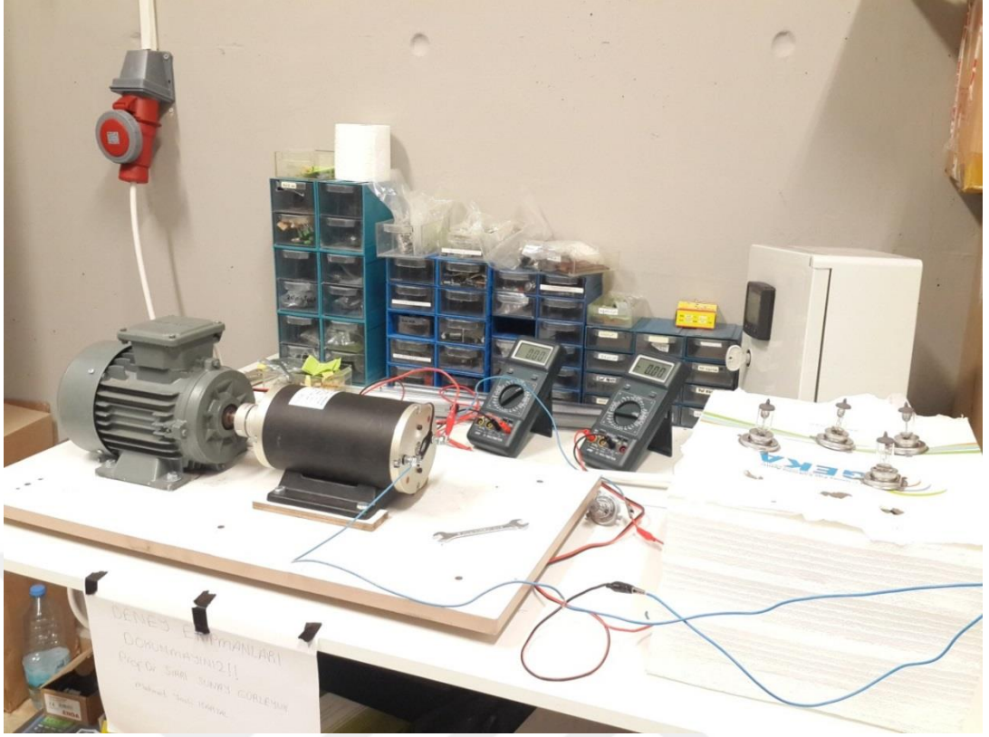
Resim 5.3. Asenkron motor – DC generatör bağlantı düzeneği yandan görünüm
