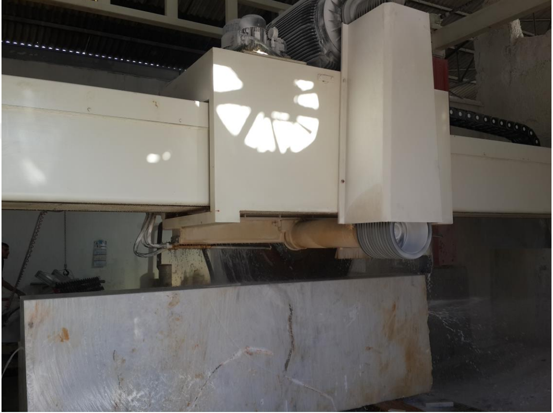
Resim 5.13. GM2E315M4A tip asenkron motor mermer kesimi
