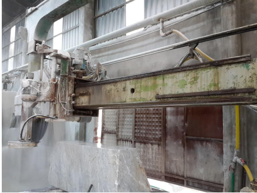
Resim 5.14. GM2E315S4 tip asenkron motor mermer kesimi
