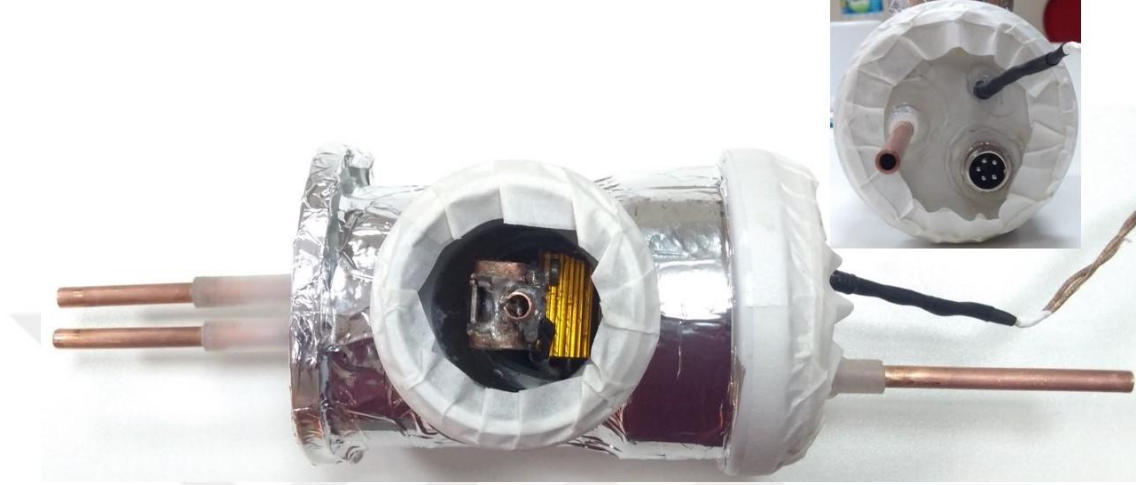
Şekil 2.20. Sıcaklık ayar ve iletim kısmında yapılan yalıtım çalışması ve tasarıma uygun hale getirilmesi
