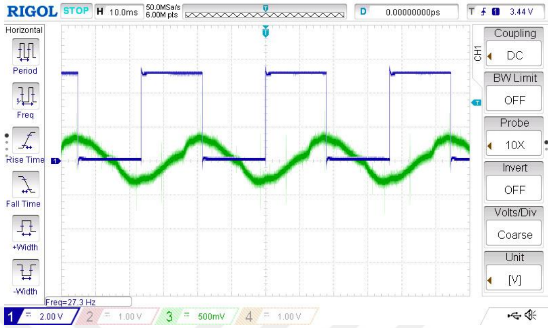
Şekil 3.4. TÖM sisteminde algılayıcı bobinden gelen sinyal ve referans sinyalinin osiloskop görüntüsü
