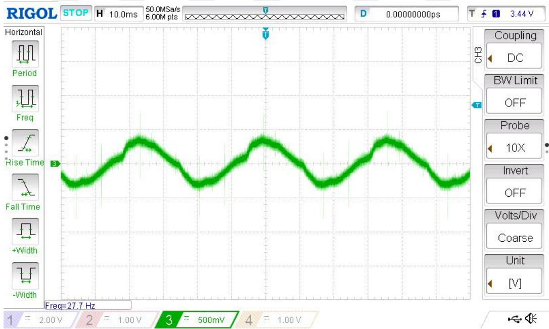
Şekil 3.3. TÖM sisteminde algılayıcı bobinden gelen sinyalin osiloskop görüntüsü
