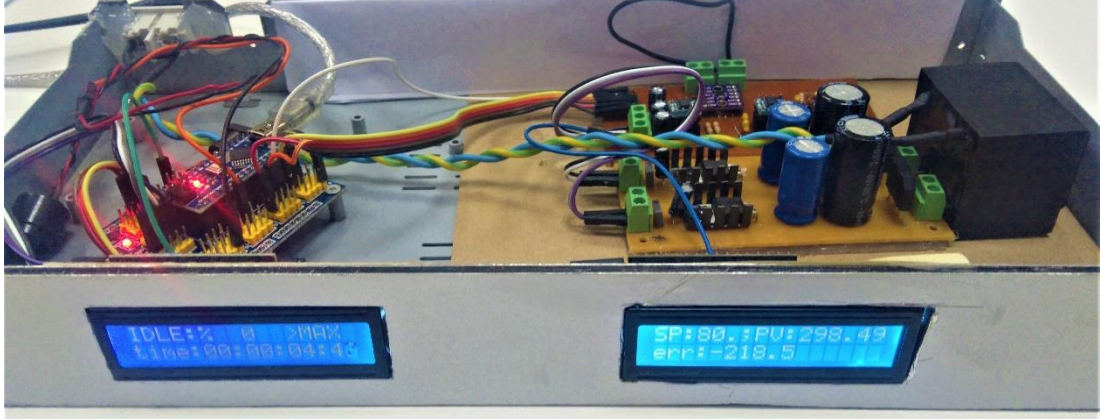
Şekil 2.13. TÖM için yapılan PID denetleyici
