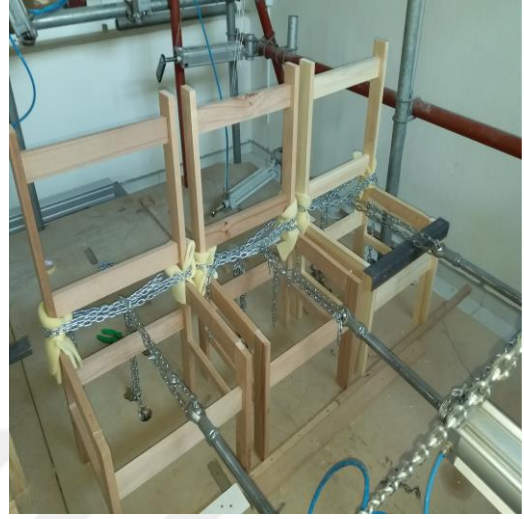
Şekil 3.13. Arkadan öne yükleme performans testi
