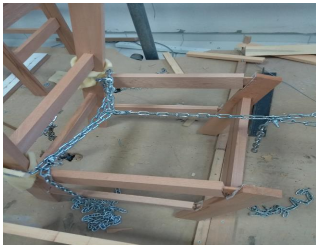
Şekil 4.8. Arkadan öne yüklenmiş deney sandalyesinin tipik deformasyonu
