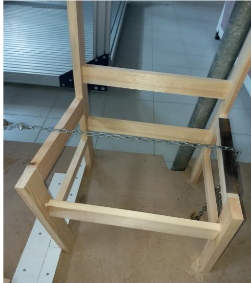
Şekil 4.18. Yanal yükleme altındaki deney sandalyesinin tipik deformasyonu
