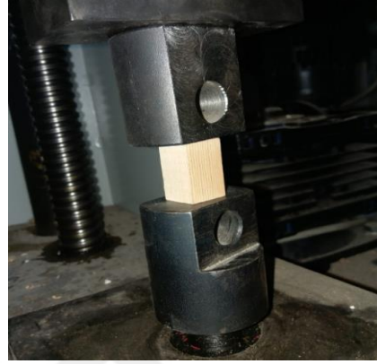
Şekil 3.4 Basınç direnci deney örneği
