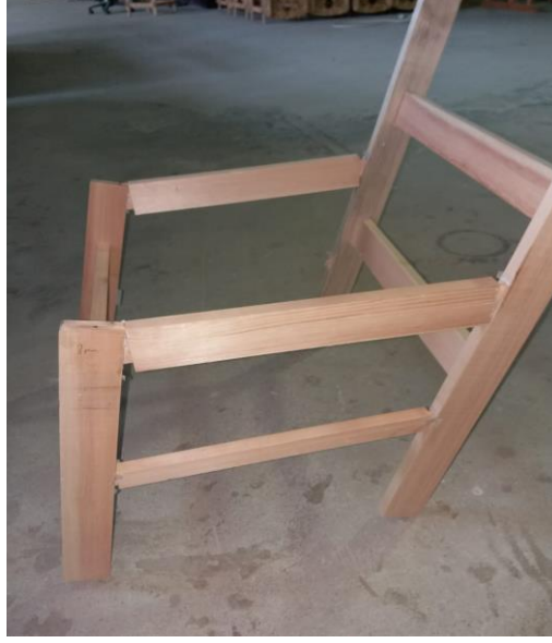
Şekil 4.2. Önden arkaya yüklenmiş deney sandalyesinin tipik deformasyonu
