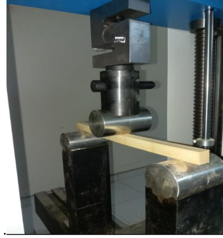
Şekil 3.5. Eğilme direnci deney düzeneği ve örneği
