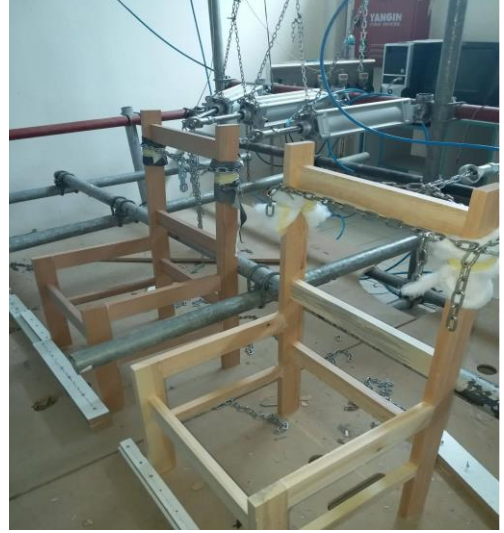
Şekil 3.15. Arkalığa önden arkaya performans testi
