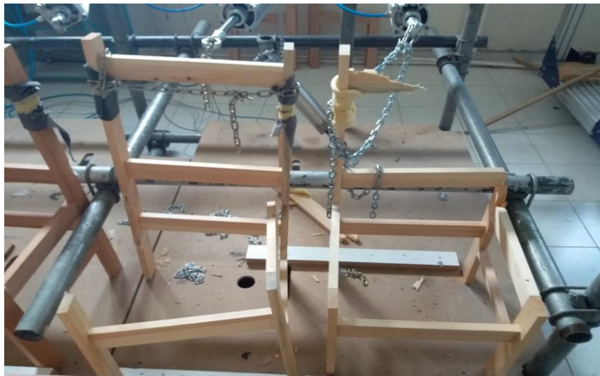
Şekil 4.13. Arkalığa önden arkaya yüklemeye deney sandalyesinin tipik deformasyonu
