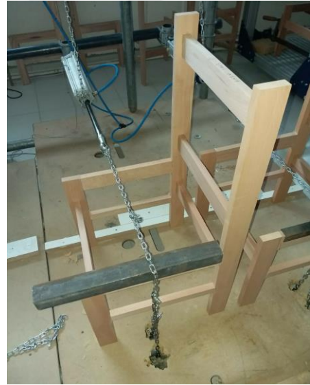
Şekil 3.14. Yanal yükleme performans testi
