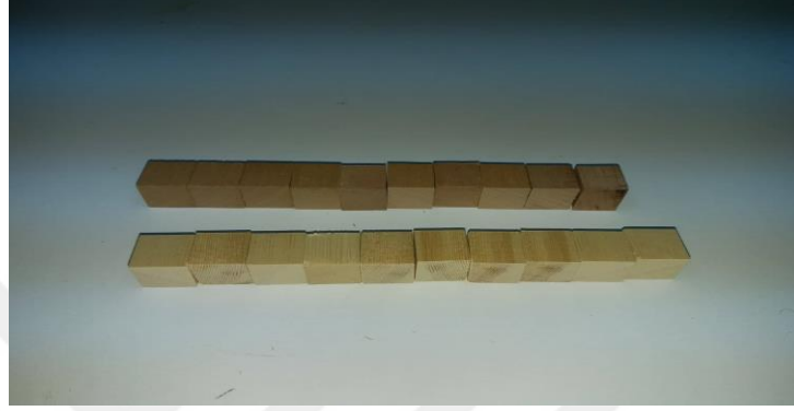
Şekil 3.2 Yoğunluk ve rutubet deney örnekleri
